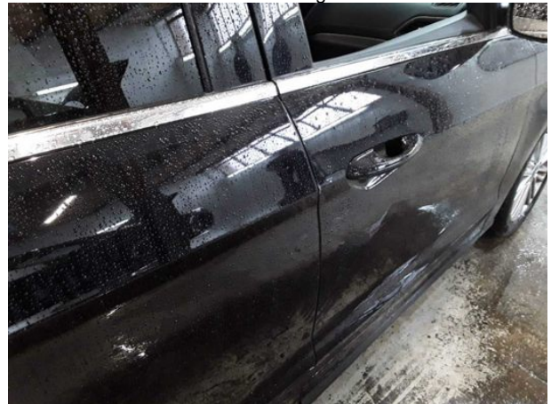
Beschädigung #2: Tür hinten rechts: Tür - verkratzt / versch... - Smart Repair
