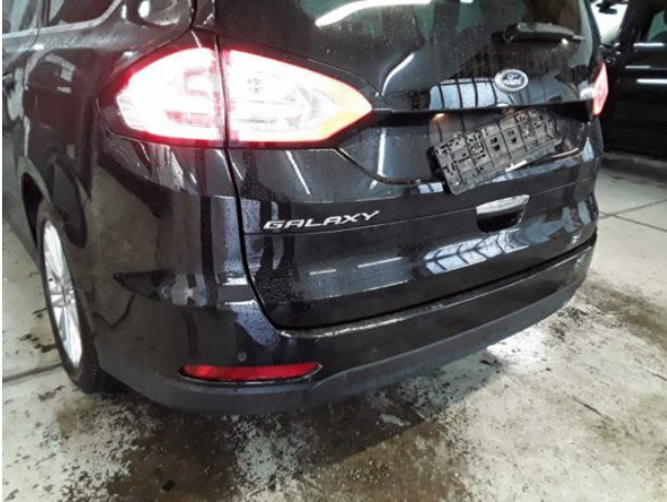
Beschädigung #1: Stossfänger hinten: Stossfänger hinten - verkratzt / verschürft - Wertminderung
