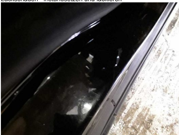
Beschädigung #4: Seitenwand rechts: Einstieg - Delle / Lackschaden - instandsetzen und lackieren
