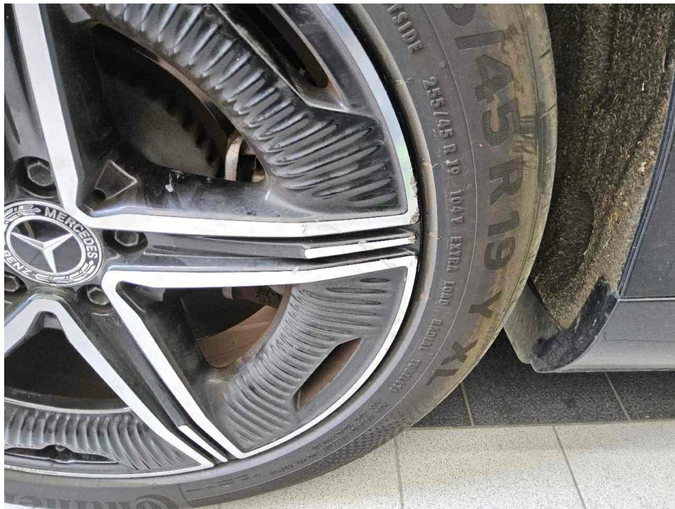
Bild 32 : Felge hinten links, hinten rechts verkratzt mit Materialabtrag
