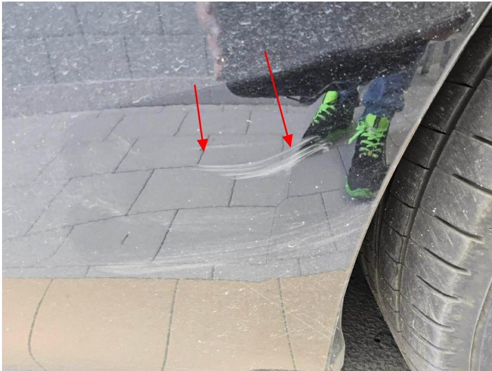
Bild 30 : Kotflügel vorne rechts Lackierung, verschrammt, lackieren mit Lackaufbau
