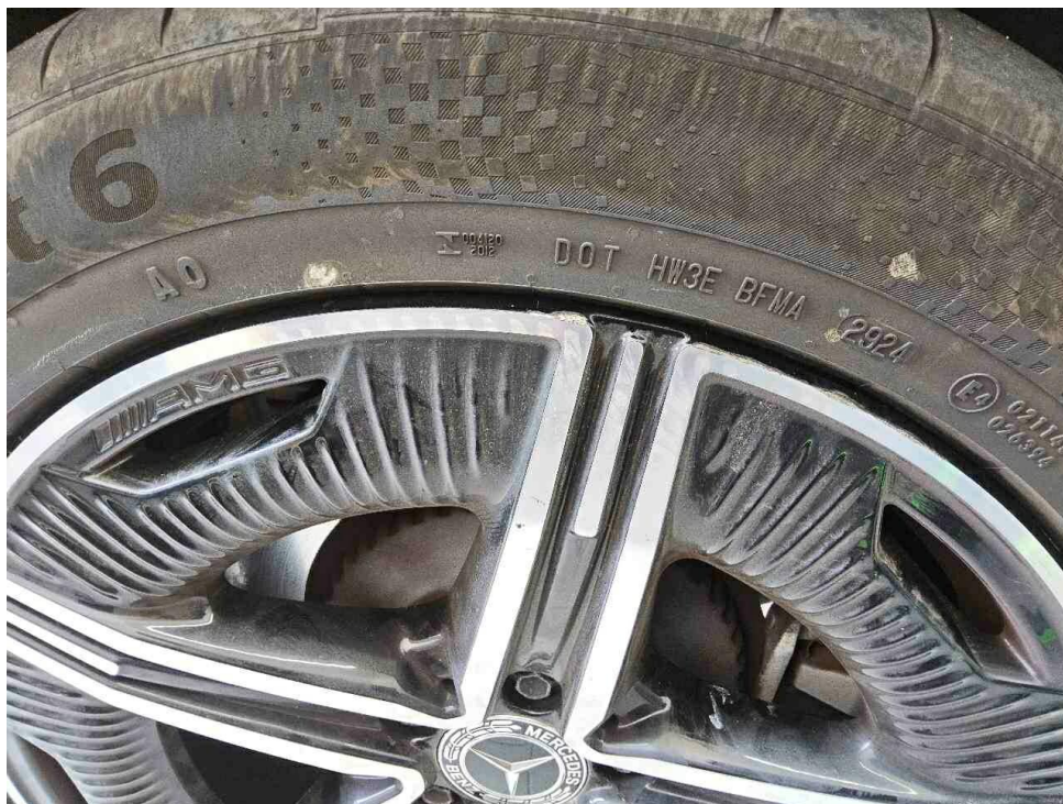
Bild 33 : Felge hinten links, hinten rechts verkratzt mit Materialabtrag
