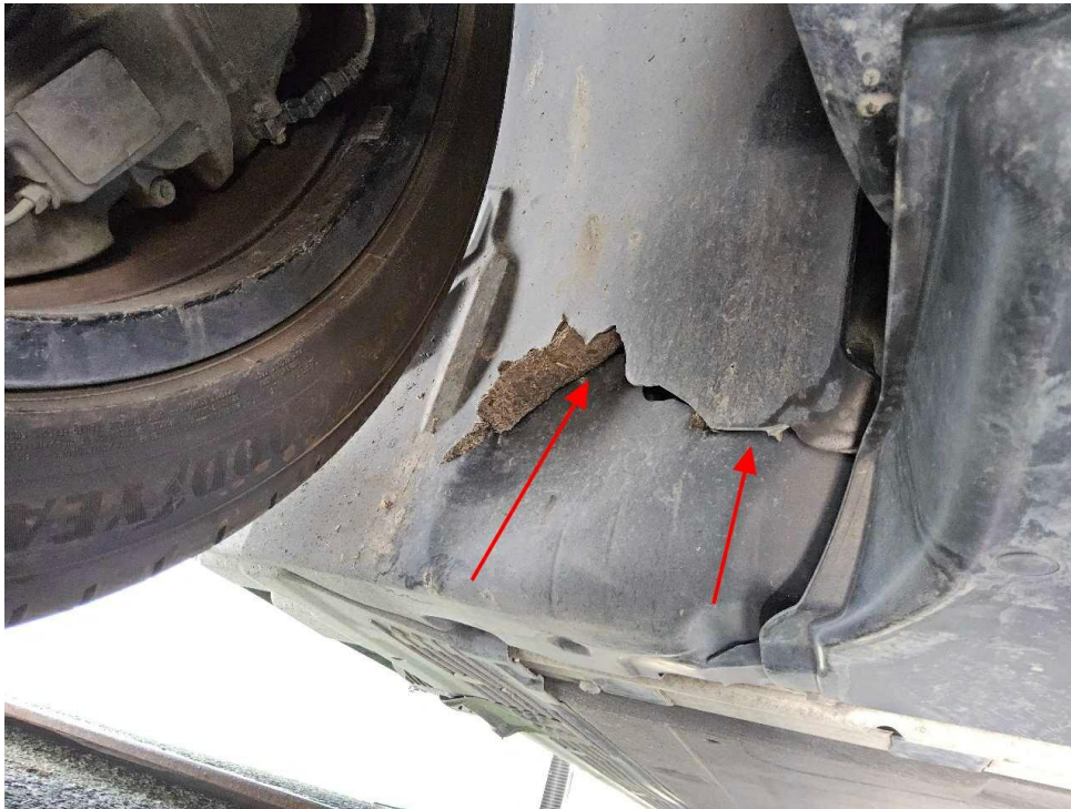
Bild 20 : Radhausschale vorne rechts gebrochen
