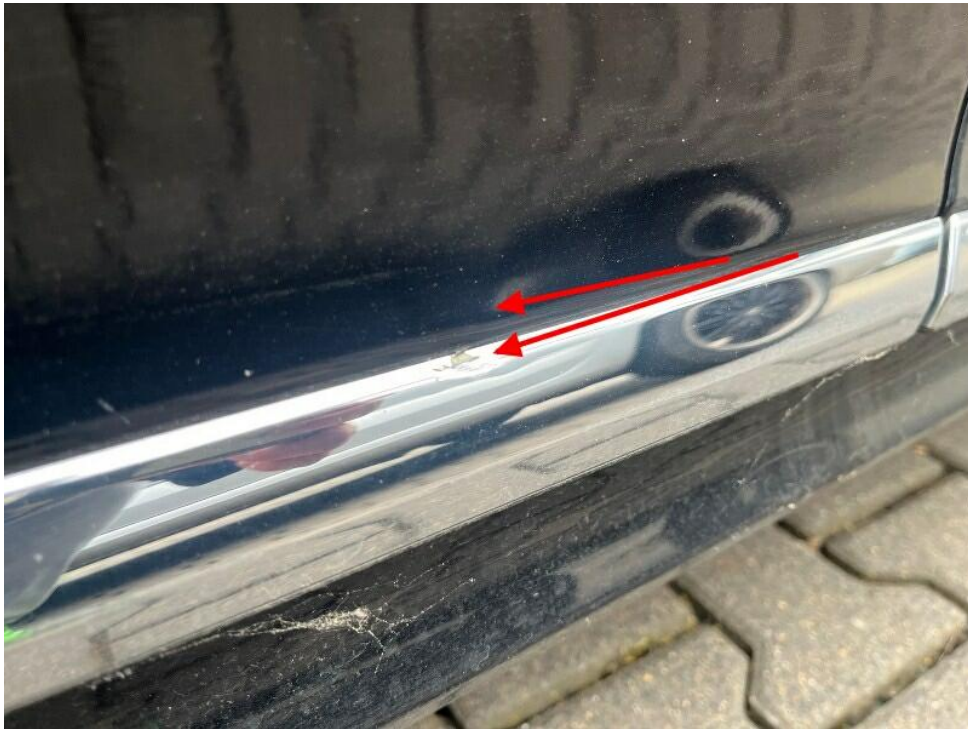
Bild 22 : Tür hinten rechts eingedellt und Zierleiste verschrammt
