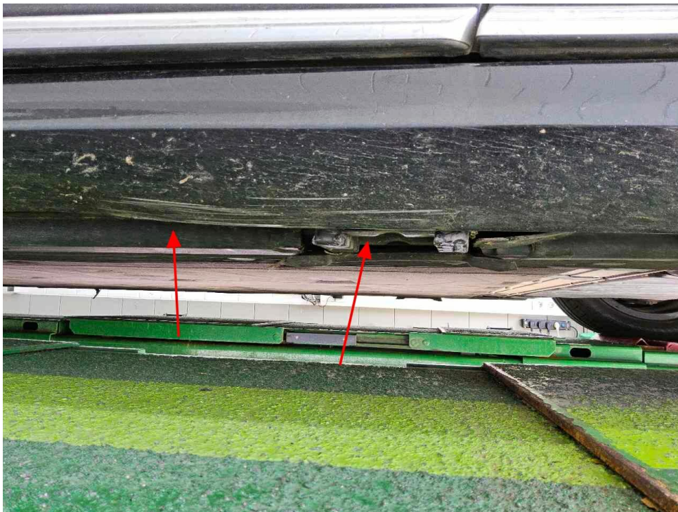
Bild 15 : Seitenschweller rechts Lackierung, verschrammt, lackieren mit Lackaufbau
