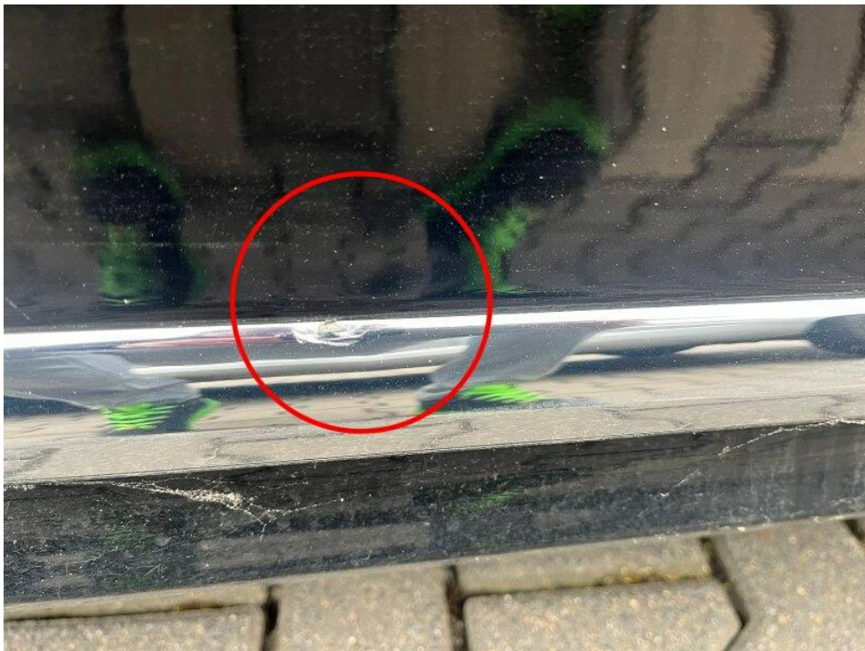
Bild 23 : Tür hinten rechts eingedellt und Zierleiste verschrammt
