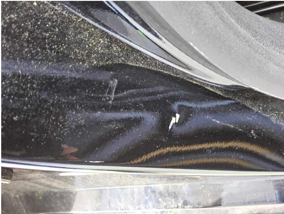
Bild 24 : Tür vorne rechts Einstieg Lackierung, verschrammt, smart repair
