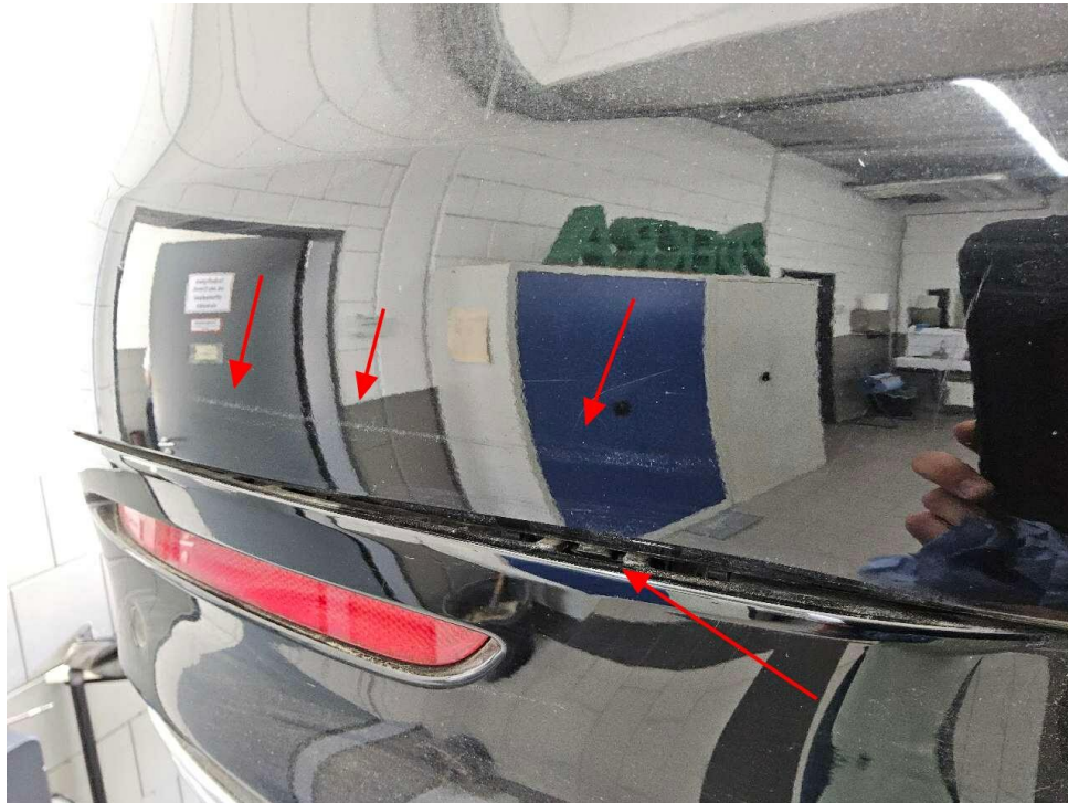
Bild 18 : Stoßfänger hinten verschrammt und deformiert
