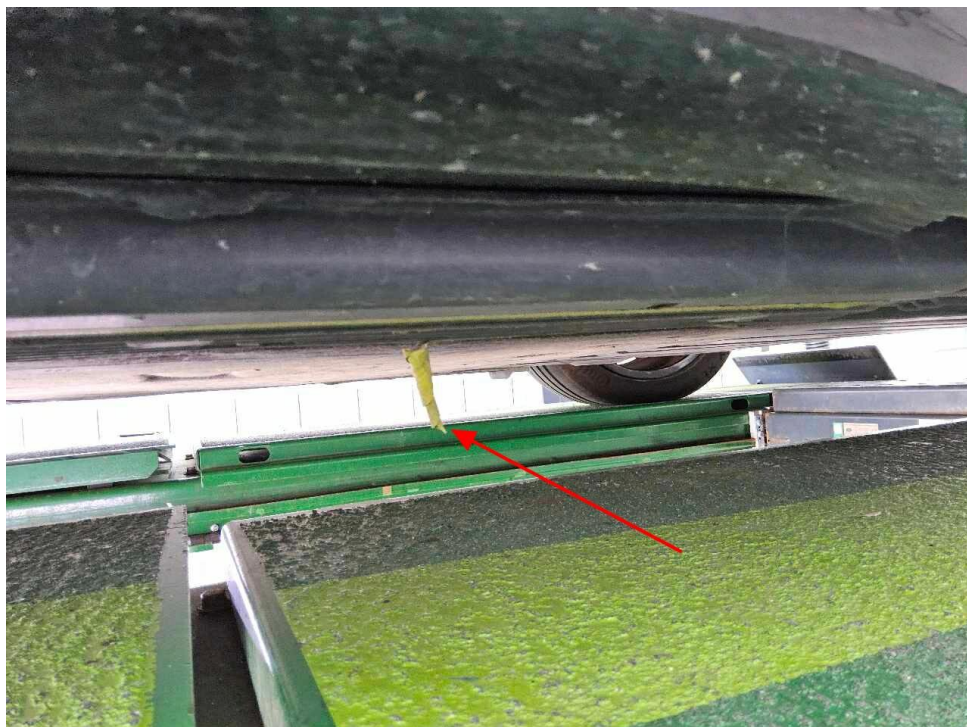
Bild 19 : Schweller links Klebebandrückstände
