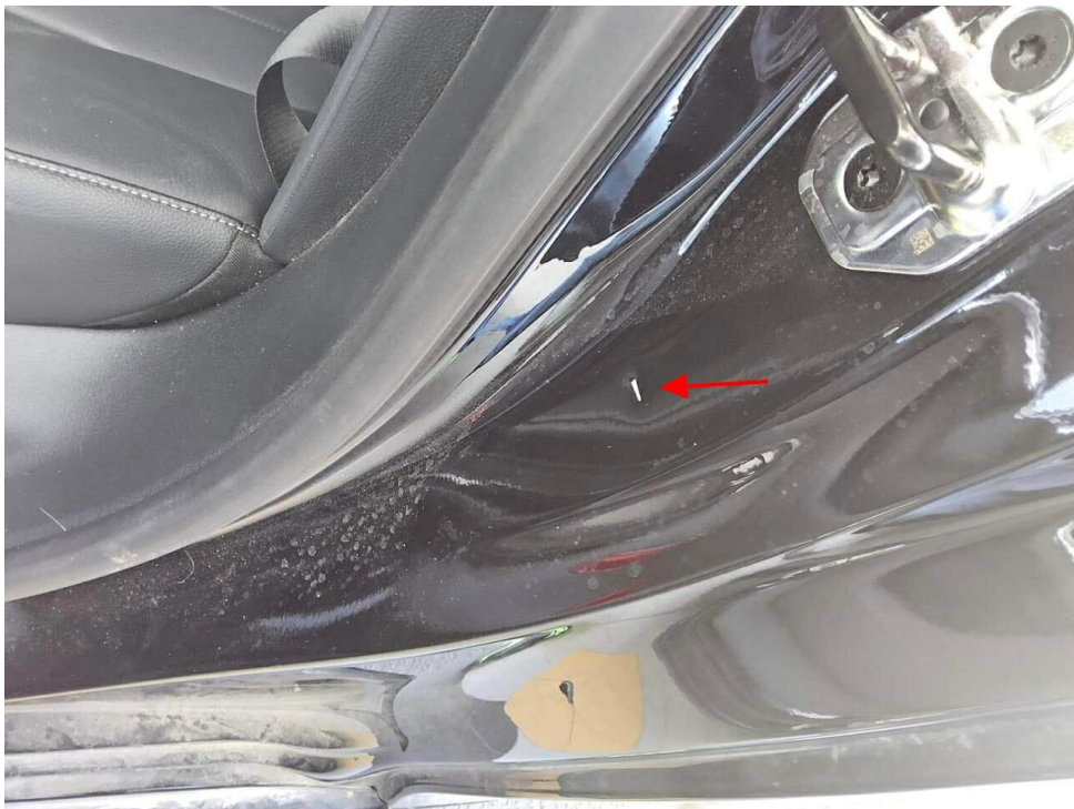
Bild 29 : Tür hinten links Einstieg Lackierung, verschrammt, smart repair
