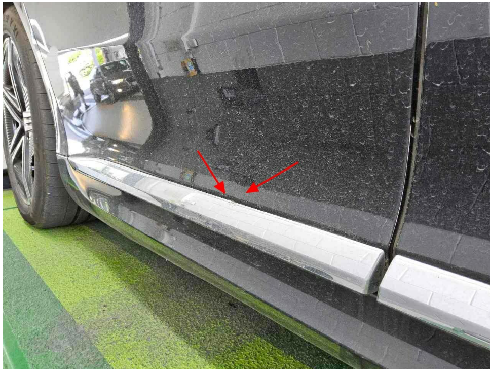
Bild 16 : Tür hinten rechts eingedellt und Zierleiste verschrammt
