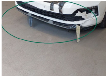
Stoßfänger Spoiler / Vorne / Gebrochen
