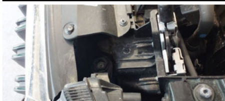
Querträger Kühler / Vorne / Gebrochen
