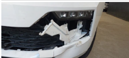
Stoßfängergrill / Vorne Links / Gebrochen
