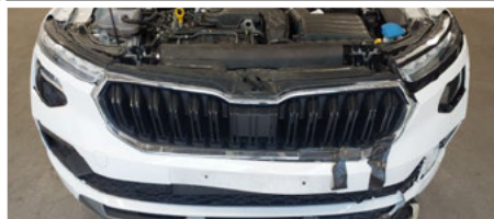
Stoßfängergrill / Vorne / Gebrochen
