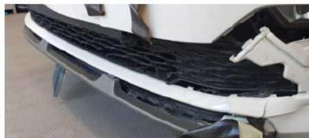
Stoßfängergrill / Vorne / Gebrochen
