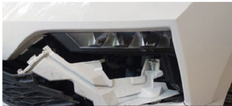
Nebelscheinwerfer / Vorne Links / Gebrochen
