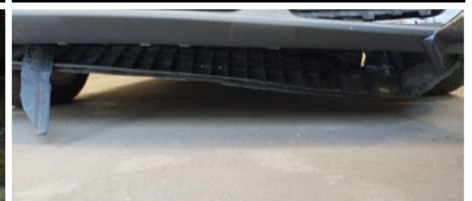
Motorabdeckung / Unten Unten / Gebrochen
