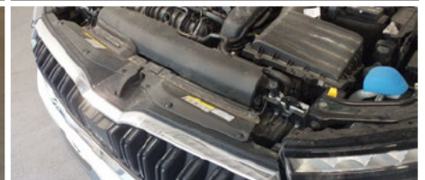
Querträger Kühler / Vorne / Gebrochen
