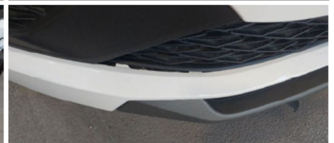
Stoßfängergrill / Vorne Rechts / Gebrochen
