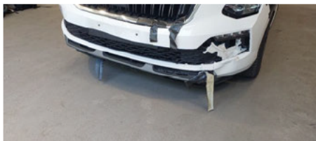
Stoßfängergrill / Vorne / Gebrochen
