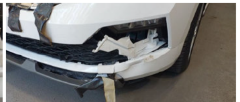
Stoßfängergrill / Vorne Links / Gebrochen
