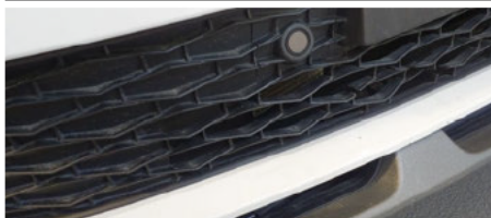
Stoßfängergrill / Vorne Rechts / Gebrochen
