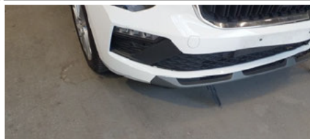
Stoßfängergrill / Vorne Rechts / Gebrochen
