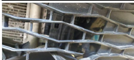
Querträger Kühler / Vorne / Gebrochen
