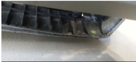
Motorabdeckung / Unten Unten / Gebrochen
