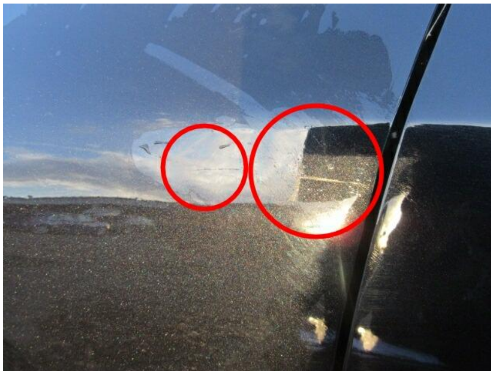
Bild 14 : Kotflügel vorne links Kratzer
