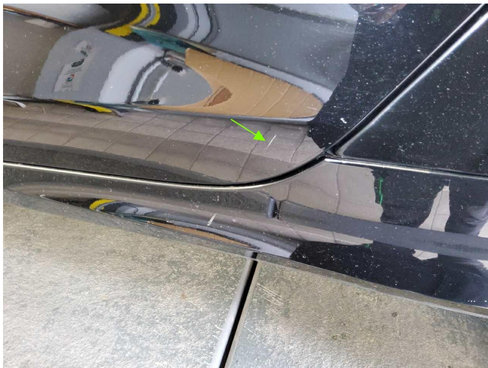
Bild 41 : Türe hinten links unten Kratzer
