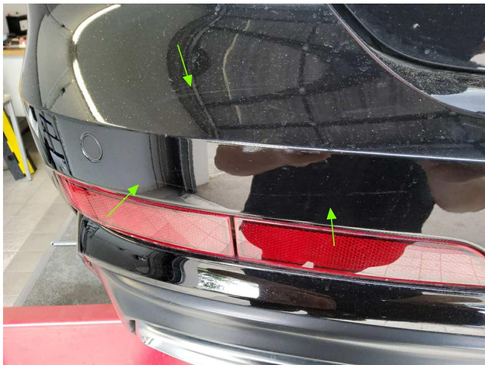
Bild 46 : Stossfänger hinten mehrere Kratzer und Kerben
