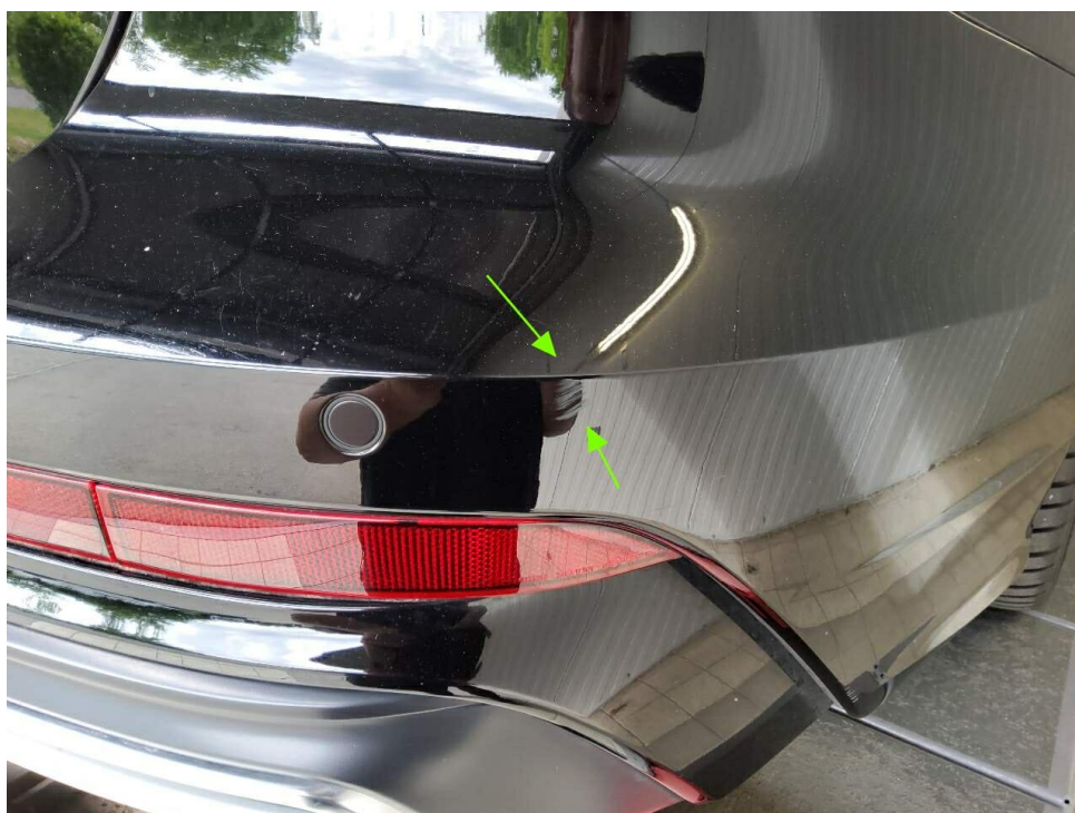
Bild 44 : Stossfänger hinten mehrere Kratzer und Kerben
