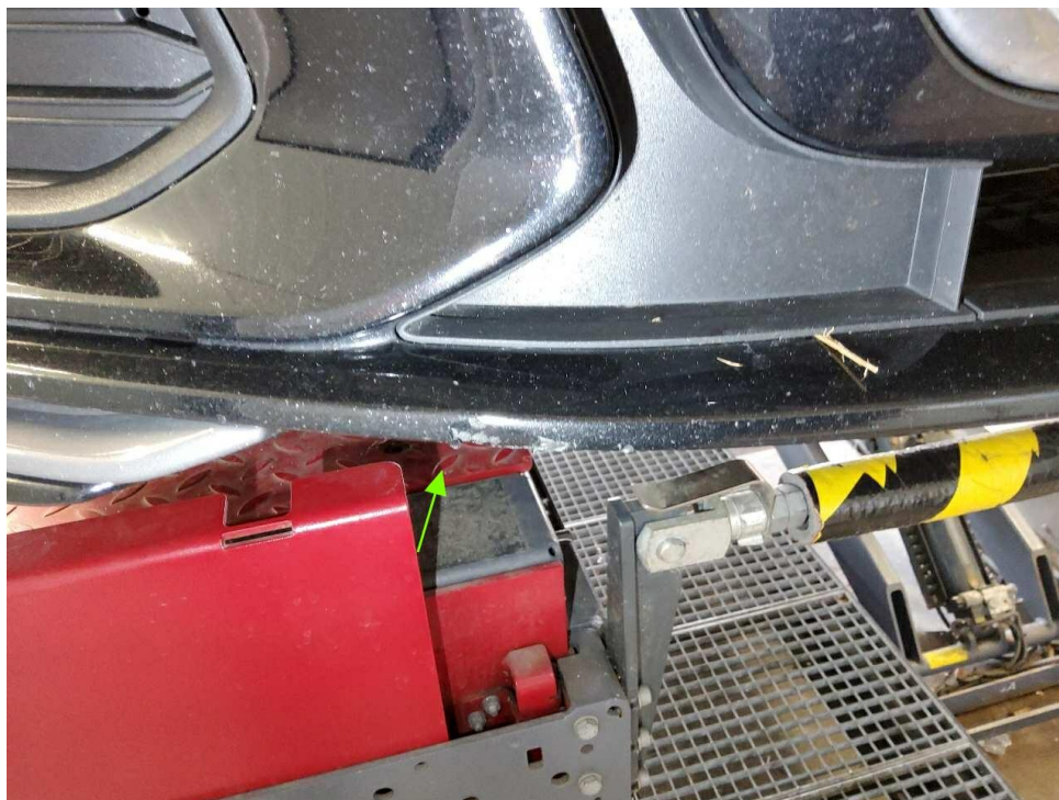
Bild 37 : Stossfänger vorn gerissen, Kratzer und viele Steinschläge
