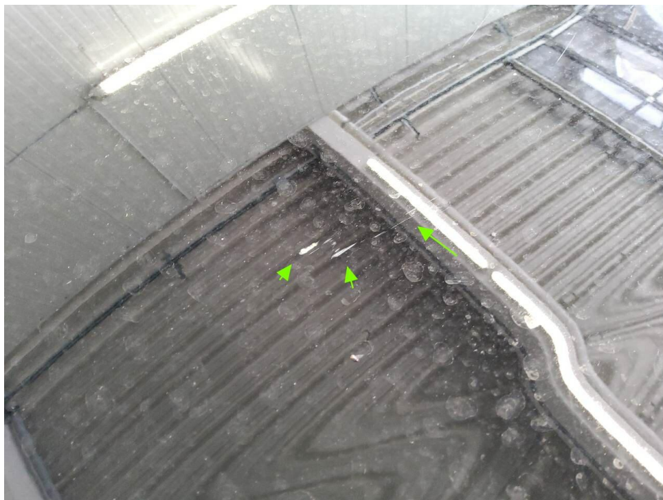
Bild 51 : Motorhaube Steinschläge und Kratzer
