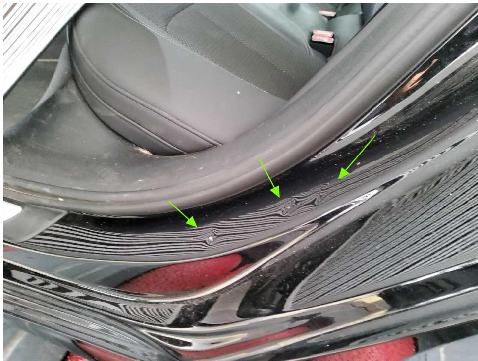
Bild 21 : Einstieg hinten links Dellen mit Lackbeschädigung
