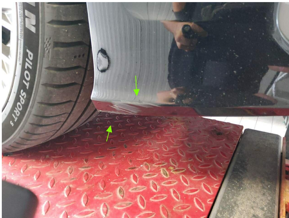
Bild 39 : Stossfänger vorn gerissen, Kratzer und viele Steinschläge
