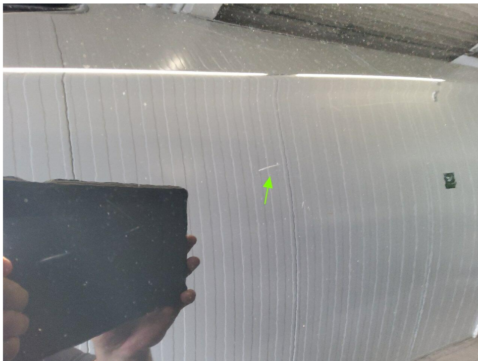
Bild 47 : Türe hinten rechts Kratzer
