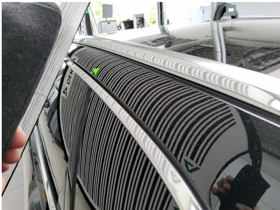
Bild 30 : Hagelähnliche Dellen im Dachbereich
