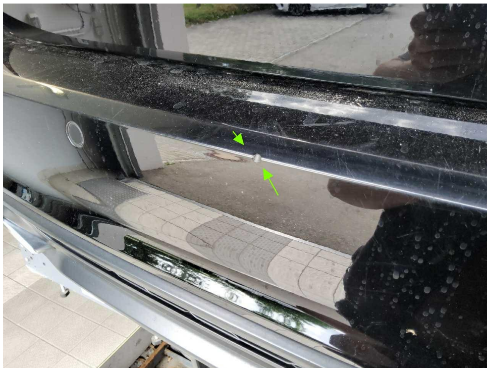
Bild 45 : Stossfänger hinten mehrere Kratzer und Kerben
