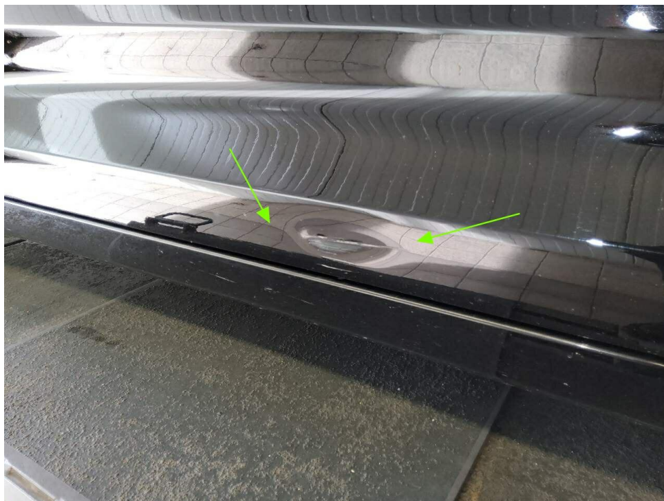
Bild 49 : Türe vorn rechts deformiert
