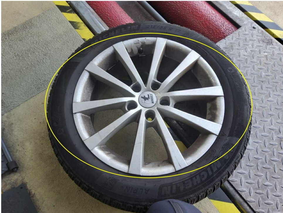
Bild 27 : Reifenflanke Winterreifen eingeschnitten
