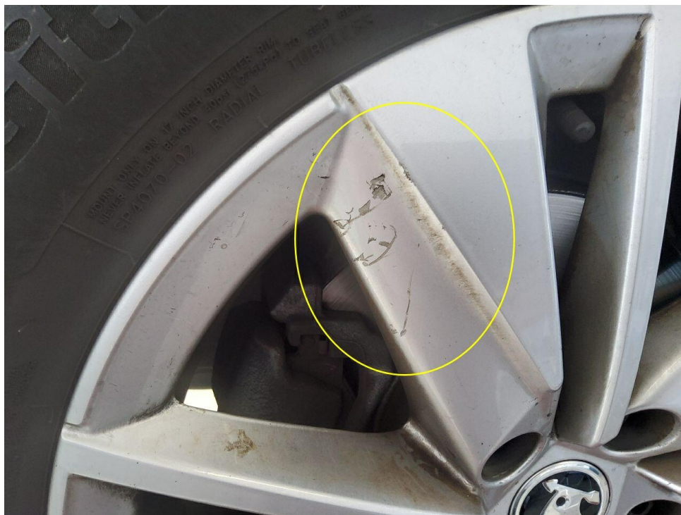
Bild 18 : Alufelge vorn links verschrammt
