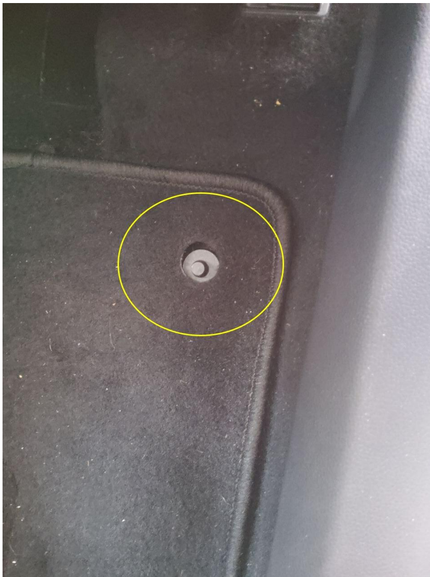
Bild 37 : Veriegelung Fußmatte vorn links fehlt
