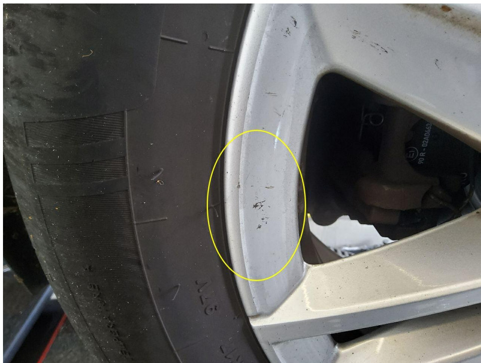
Bild 19 : Aluelge hinten links lokal verschrammt
