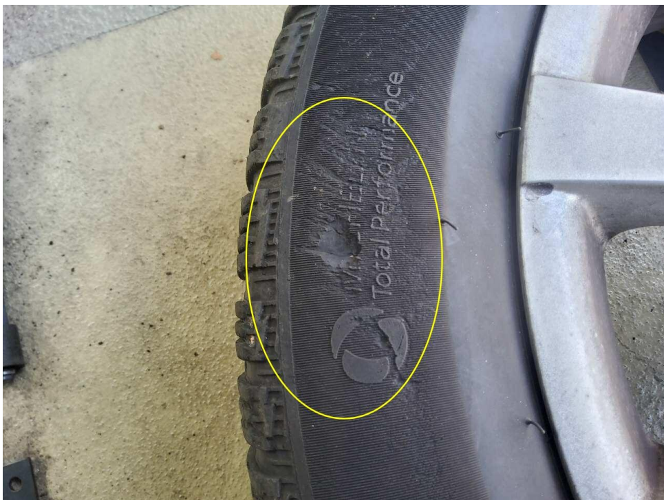
Bild 28 : Reifenflanke Winterreifen eingeschnitten
