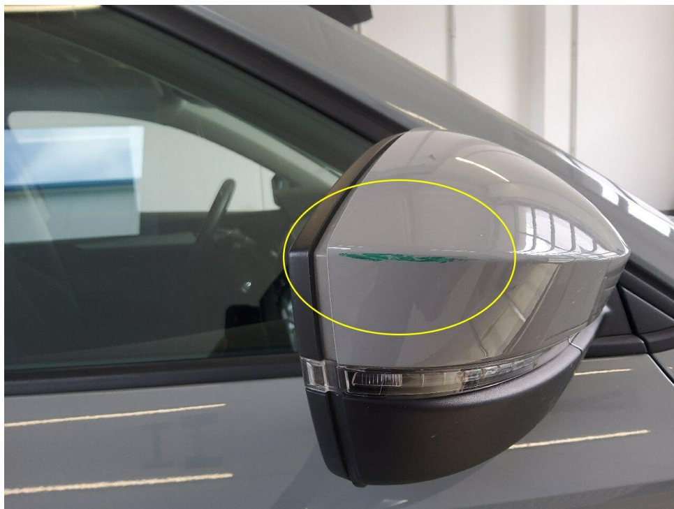
Bild 23 : Spiegelkappe rechts Materialauftrag
