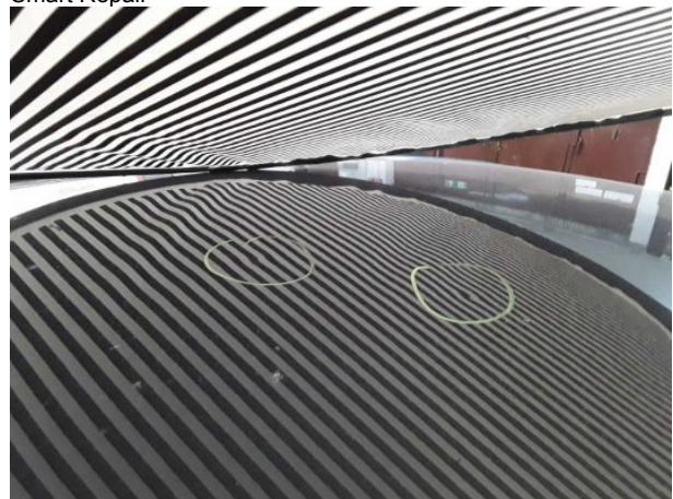
Beschädigung #10: Fahrzeugdach: Dach - Delle(n) - sanft instandsetzen
