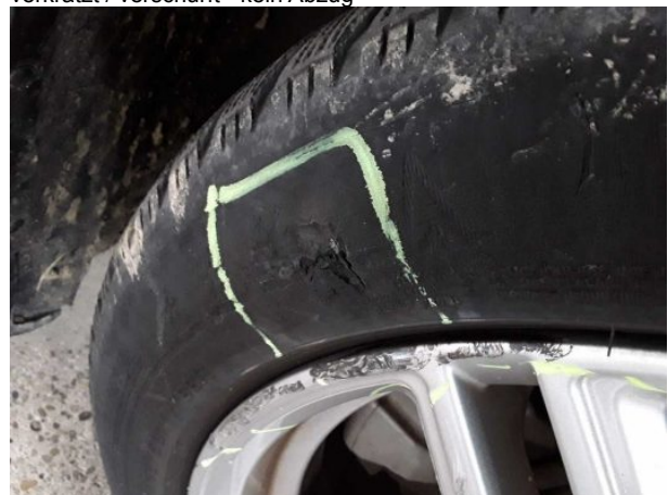
Beschädigung #3: Rad/Reifen: Reifen vorn rechts - beschädigt - kein Abzug
