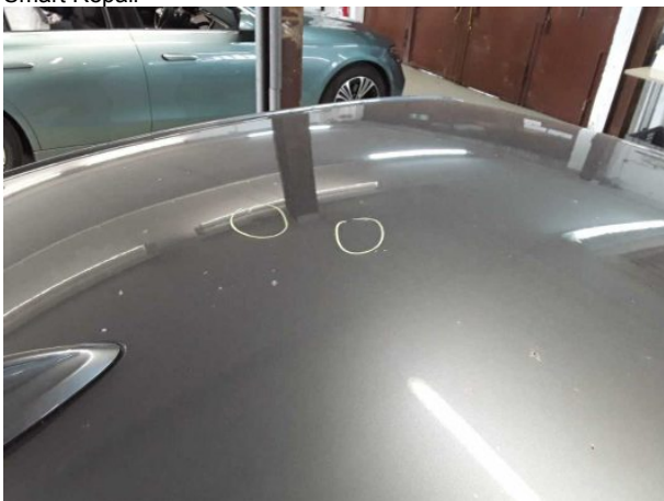
Beschädigung #10: Fahrzeugdach: Dach - Delle(n) - sanft instandsetzen
