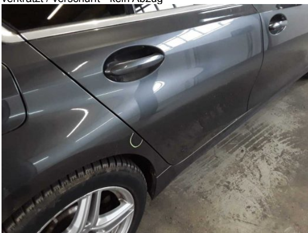
Beschädigung #7: Seitenwand rechts: Seitenwand - Delle(n) - sanft instandsetzen
