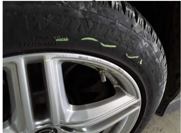
Beschädigung #2: Rad/Reifen: Leichtmetallfelge vorn links - verkratzt / verschürft - kein Abzug
