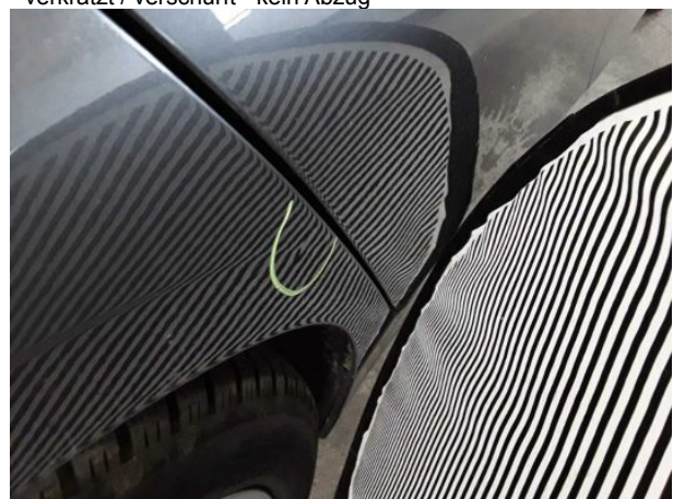
Beschädigung #7: Seitenwand rechts: Seitenwand - Delle(n) - sanft instandsetzen
