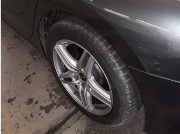
Beschädigung #1: Rad/Reifen: Leichtmetallfelge hinten links - verkratzt / verschürft - kein Abzug
