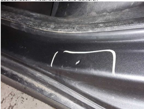
Beschädigung #12: Seitenwand links: Einstieg - Delle / Lackschaden - instandsetzen und lackieren
