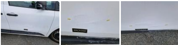
Door trim FR, Chemical polution, Replace
