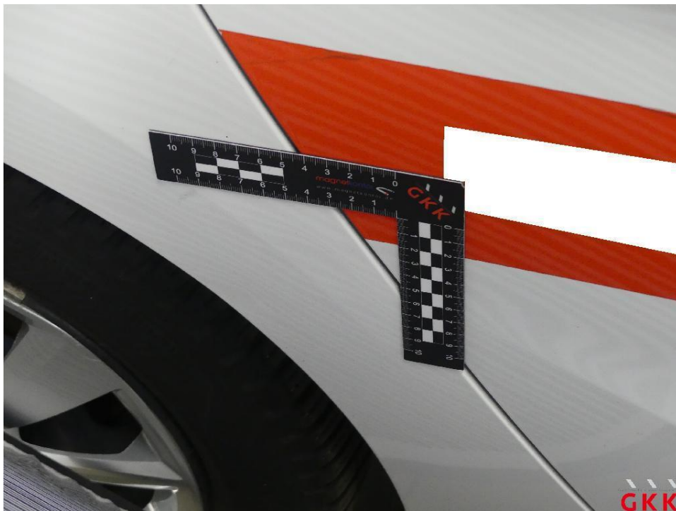
Bild 16 Seitenwand rechts, beschädigt, instand setzen - lackieren
