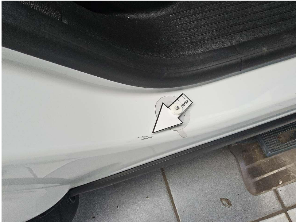
Bild 11 : Schweller im Einstiegsbereich hinten rechts zerkratzt
