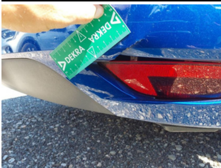
Pare-chocs / Arrière / Cassé
