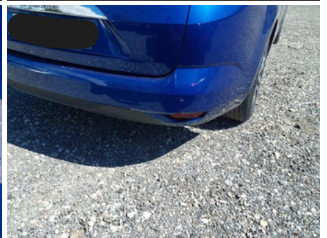
Pare-chocs / Arrière / Cassé
