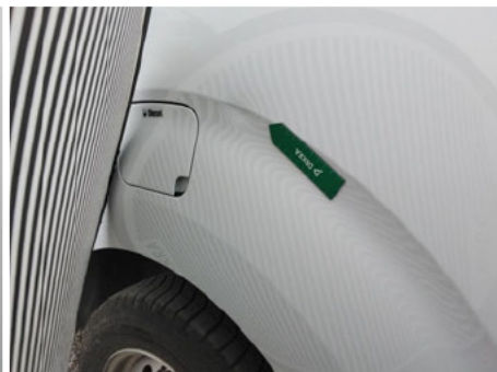
Seitenwand / Links / Delle
