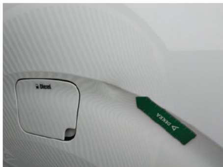
Seitenwand / Links / Delle
