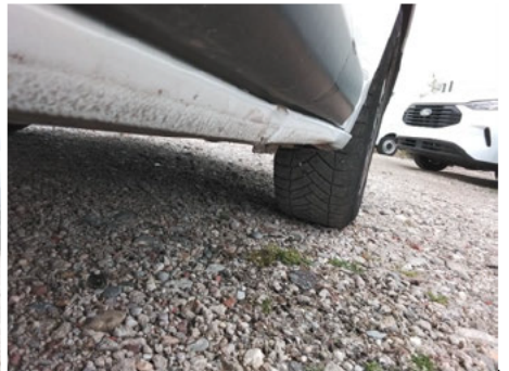
Schweller / Vorne Rechts / Delle
