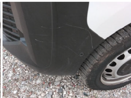
Stoßfänger unterhalb / Vorne / Kratzer
