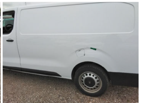
Seitenwand / Links / Delle
