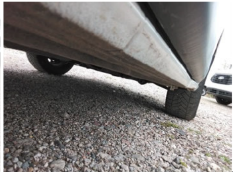
Schweller / Vorne Rechts / Delle
