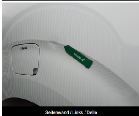
Seitenwand / Links / Delle
