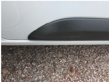
Türzerleiste / Rechts / Kratzer
