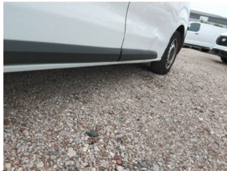
Schweller / Vorne Rechts / Delle
