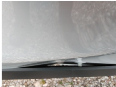
Türzerleiste / Vorne Rechts / Gebrochen
