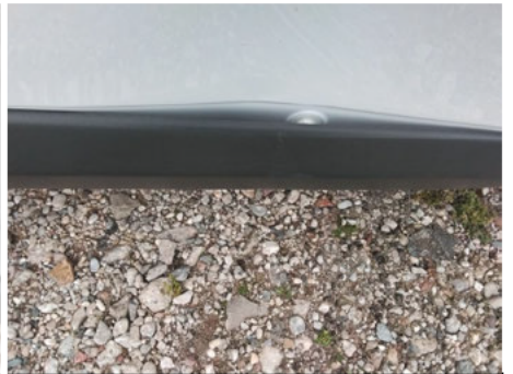
Türzerleiste / Vorne Rechts / Gebrochen
