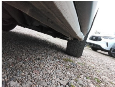
Schweller / Vorne Rechts / Delle
