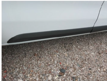
Türzerleiste / Rechts / Kratzer
