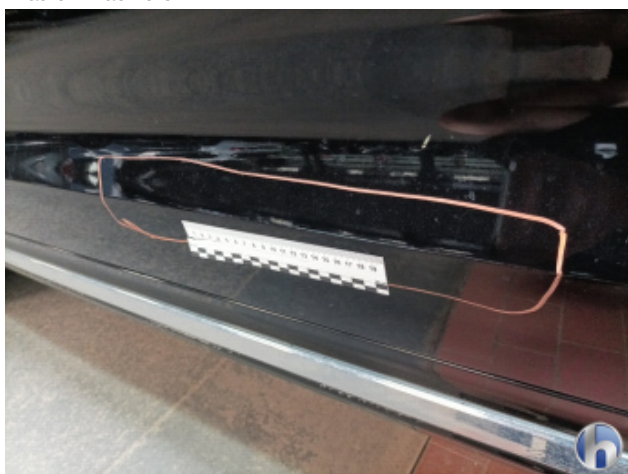
2. Tür Vorne - Links Kratzer - Lackieren
