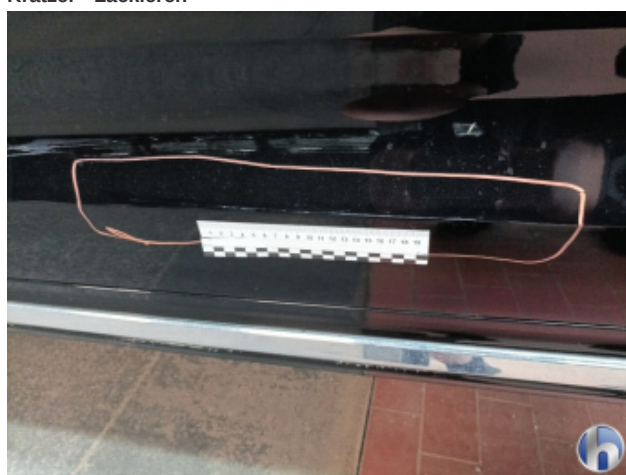
2. Tür Vorne - Links Kratzer - Lackieren
