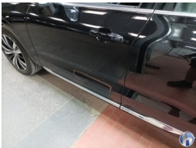
2. Tür Vorne - Links Kratzer - Lackieren
