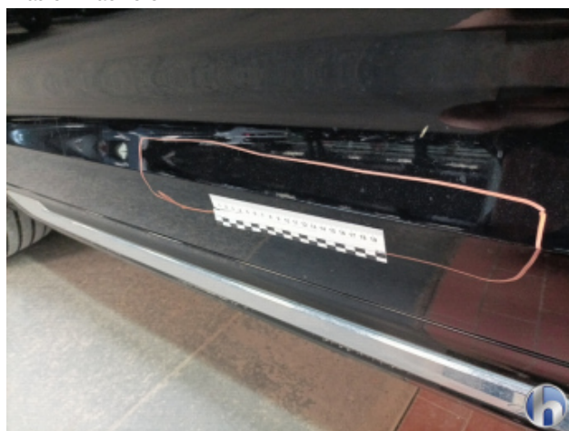
2. Tür Vorne - Links Kratzer - Lackieren
