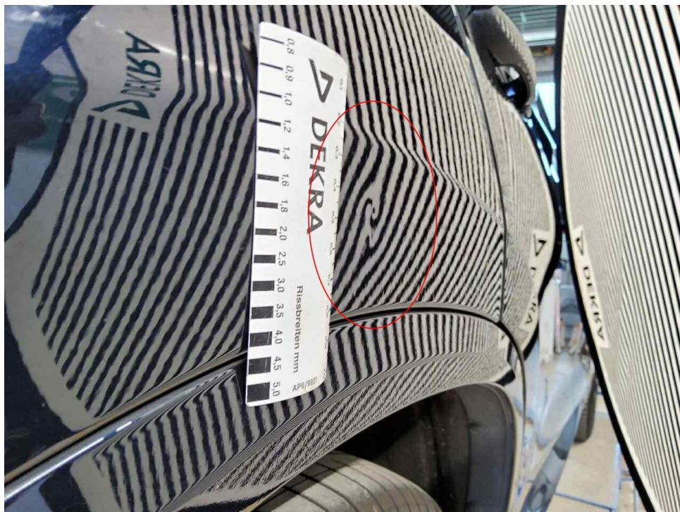
Bild 28 : Seitenteil hinten rechts, eingedellt
