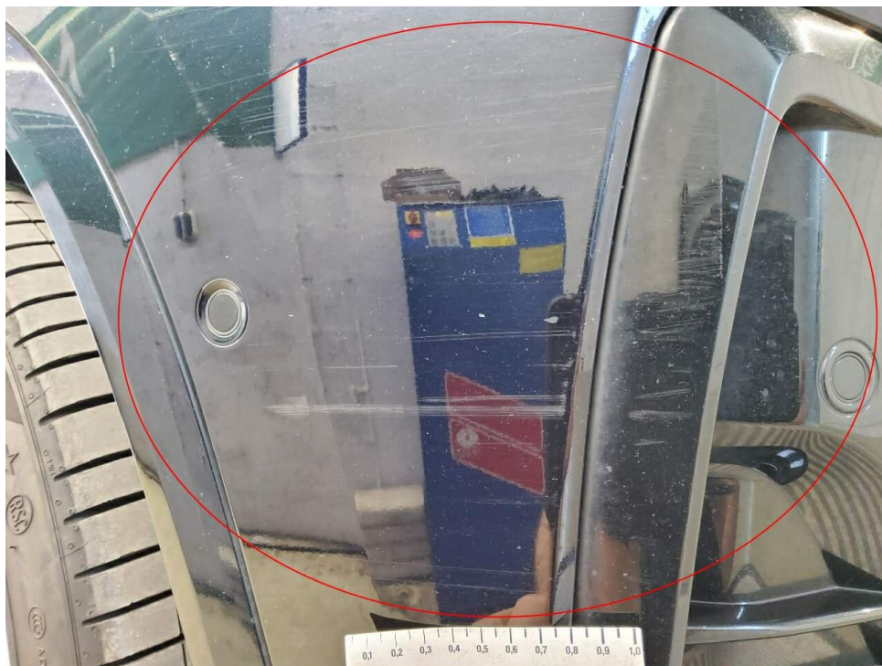
Bild 23 : Stoßfänger vorne, deformiert
