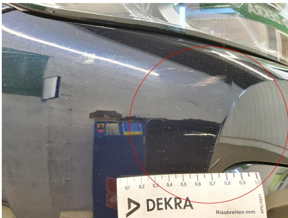
Bild 24 : Stoßfänger vorne, deformiert
