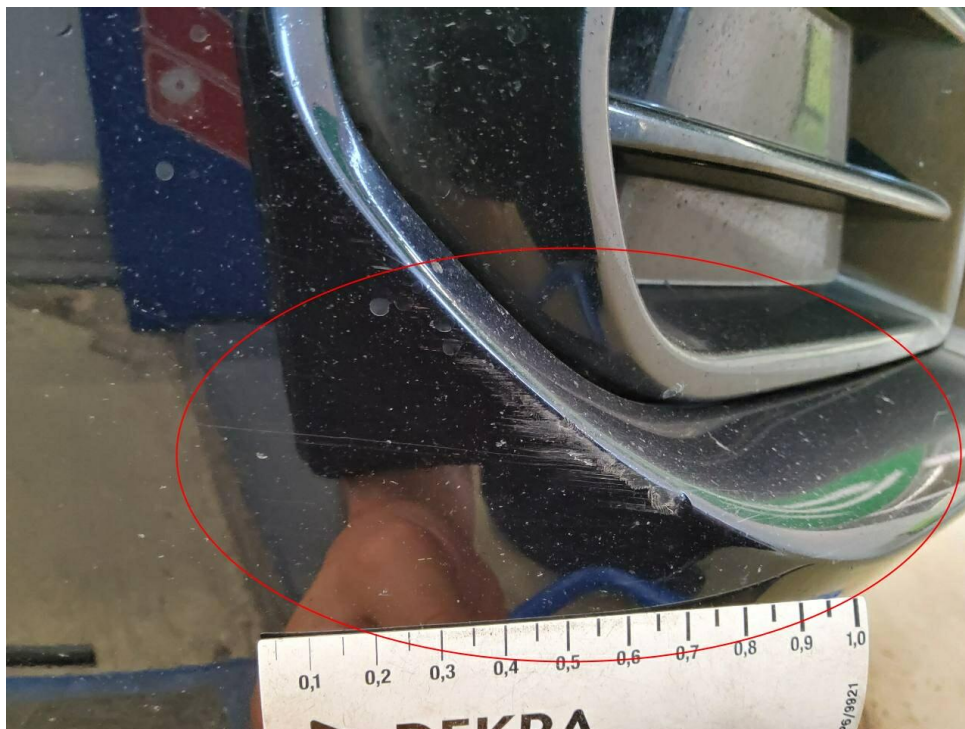
Bild 21 : Stoßfänger vorne, deformiert
