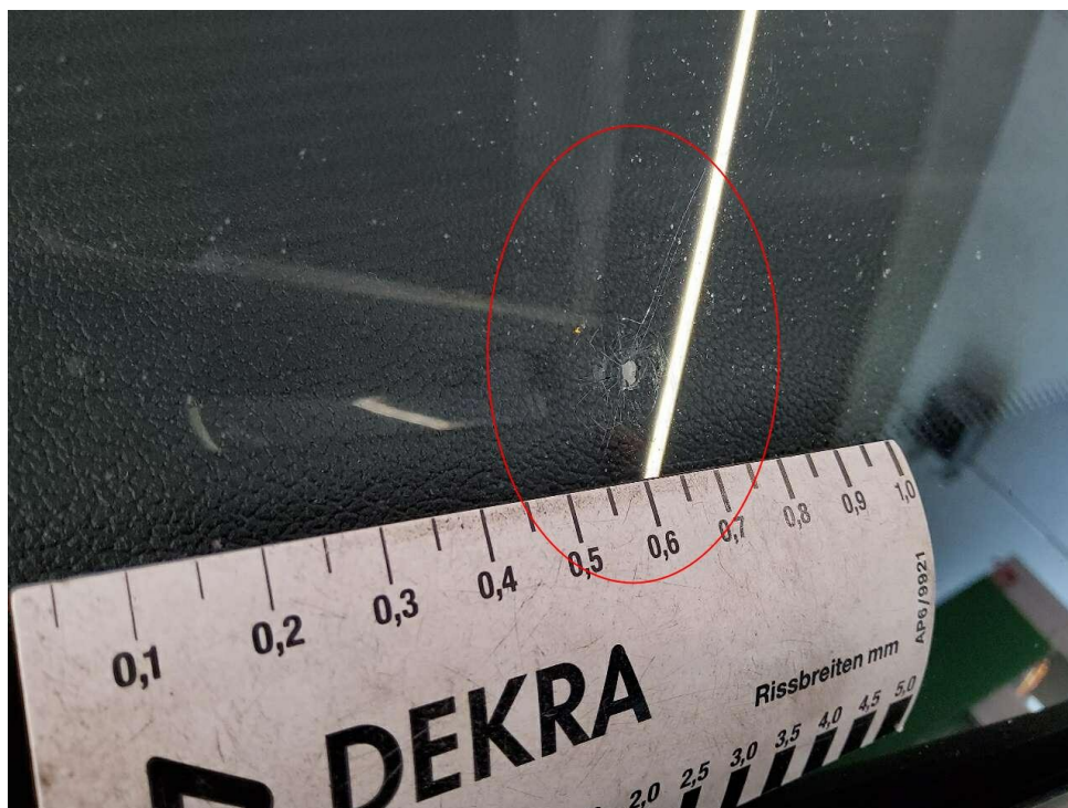
Bild 19 : Frontscheibe, Steinschlag mit Rissbildung
