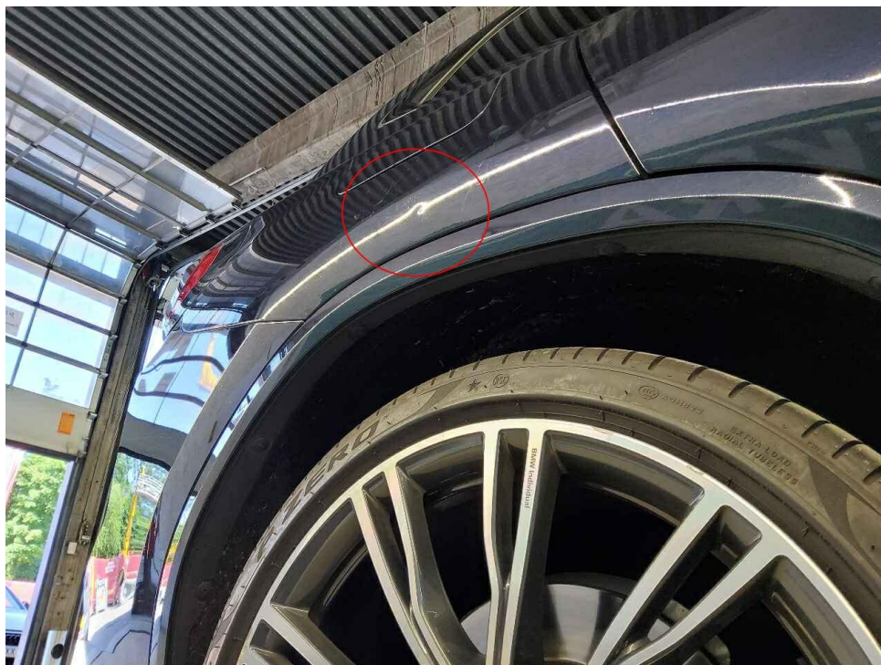
Bild 27 : Seitenteil hinten rechts, eingedellt
