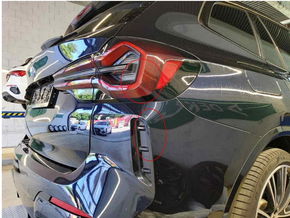
Bild 29 : Schaden Stoßfänger hinten rechts (Nahbereich Radarsensor)
