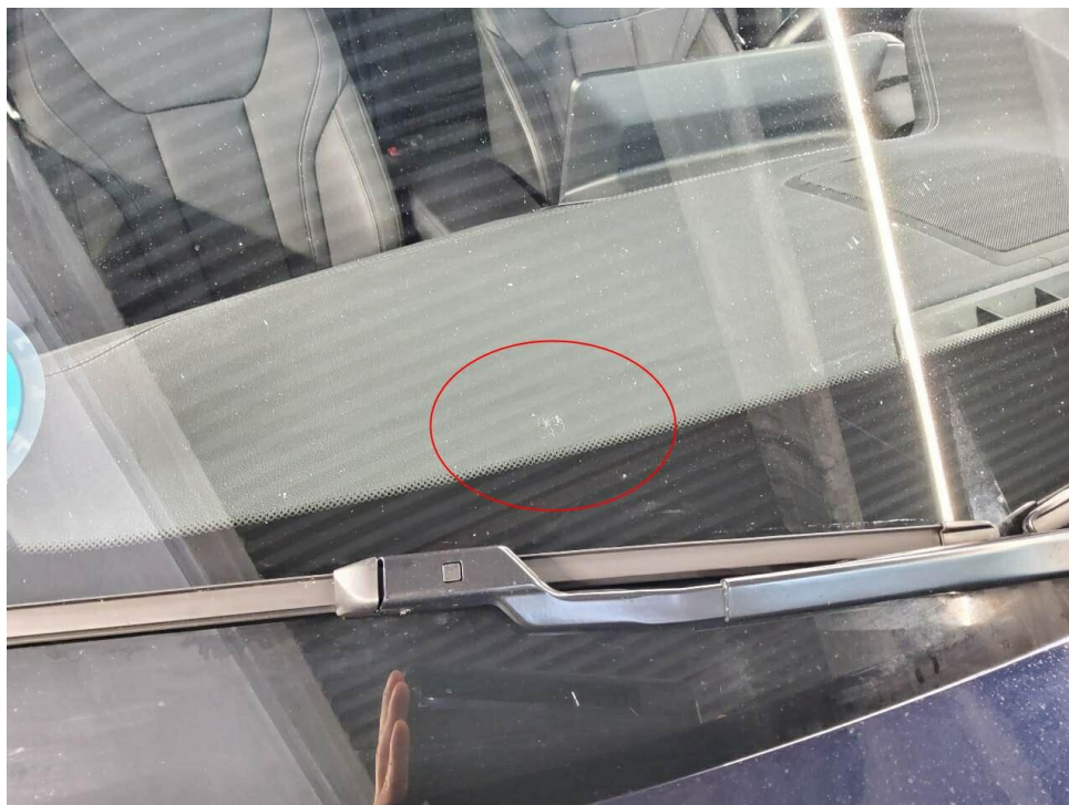
Bild 18 : Frontscheibe, Steinschlag mit Rissbildung
