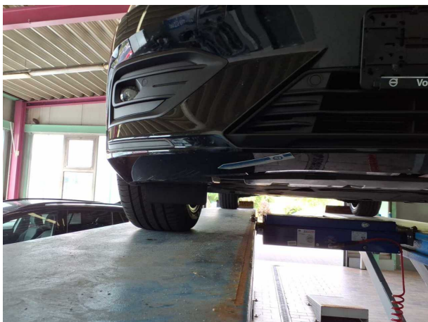
Beschädigung #2: Stossfänger vorn: Spoiler - Kratzer - lackieren
