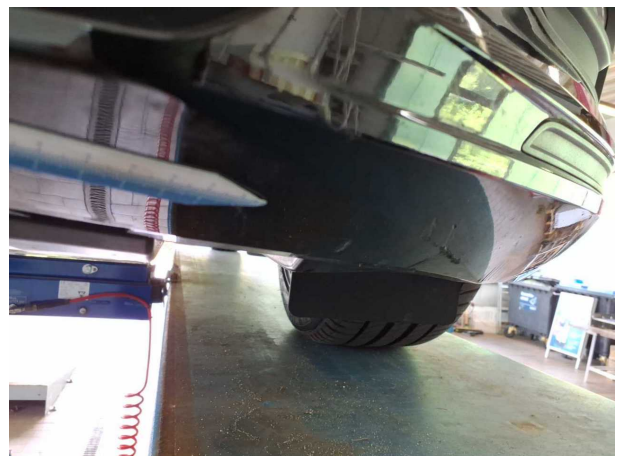
Beschädigung #2: Stossfänger vorn: Spoiler - Kratzer - lackieren
