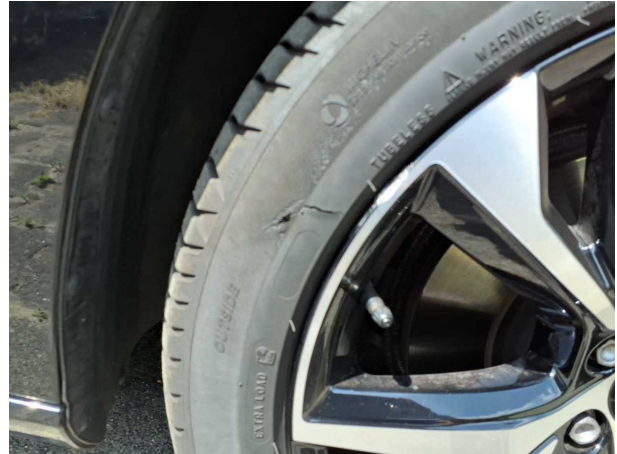
Beschädigung #1: Rad/Reifen: Reifen vorn - beschädigt - erneuern
