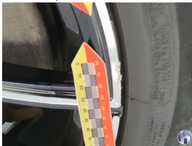
1. Felge Vorne - Rechts Kratzer - Smart Repair
