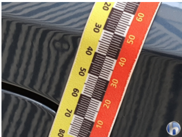
5. Seitenwand - Hinten - Links 2 Dellen - Sanft Instandsetzen
