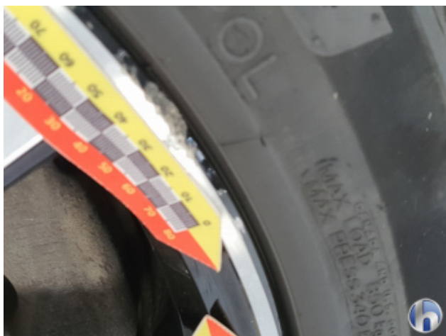
1. Felge Vorne - Rechts Kratzer - Smart Repair
