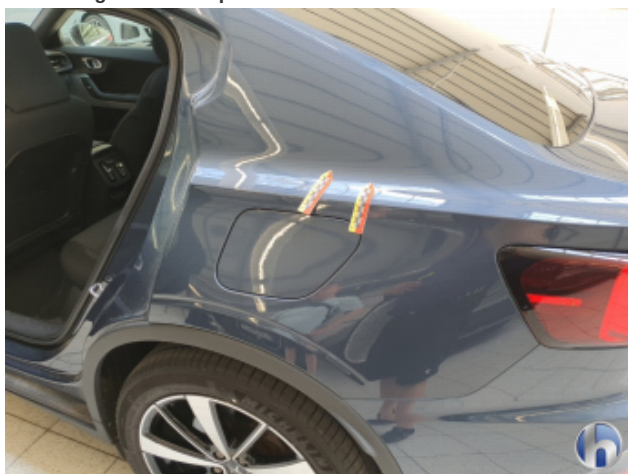
5. Seitenwand - Hinten - Links 2 Dellen - Sanft Instandsetzen
