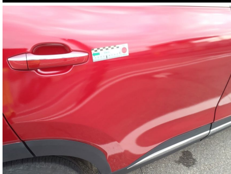
Porta / Posteriore Destro / Difetto di Esecuzione
