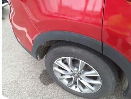
Modanatura parafrangente / Posteriore Destro / Difetto di Esecuzione
