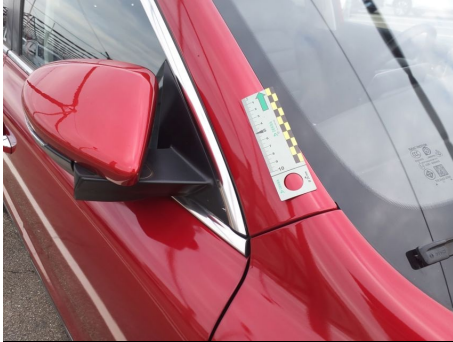
Montante tetto / Destro / Difetto di Esecuzione
