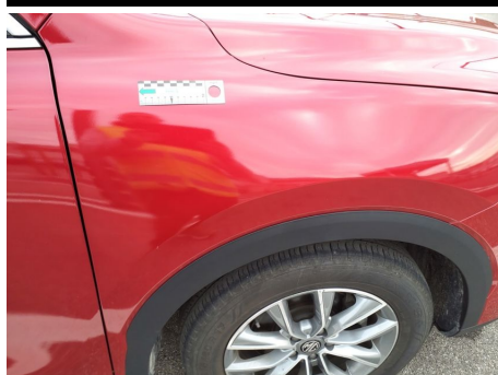
Parafango / Anteriore Destro / Difetto di Esecuzione
