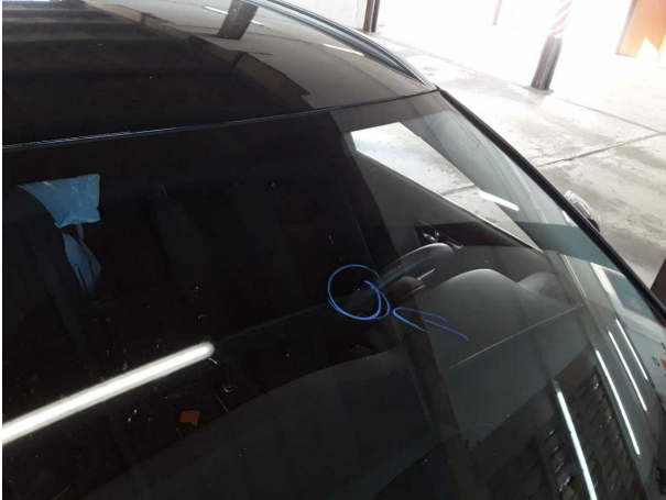
Beschädigung #2: Verglasung: Frontscheibe (Rissbildung) - Steinschlag - erneuern
