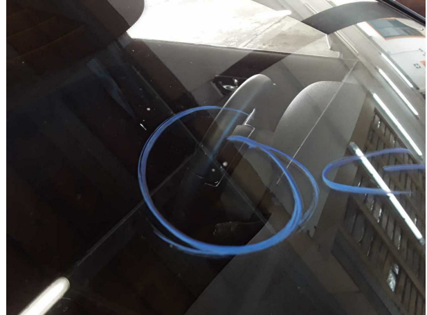
Beschädigung #2: Verglasung: Frontscheibe (Rissbildung) - Steinschlag - erneuern
