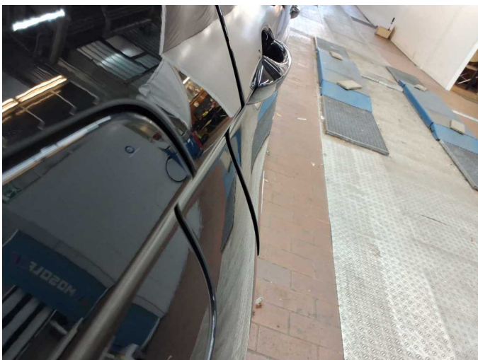
Damage 4: Door - rear right side: Door (Spaltmaße, Tür steht ab) - Incomplete - Set / adjust
