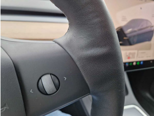
Beschädigung #1: Lenkanlage: Lenkrad (Leder löst sich) - Befund festlegen - erneuern
