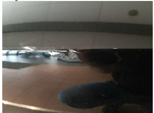
Beschädigung #2: Stossfänger vorn: Stossfänger vorn - Delle / Lackschaden - instandsetzen und lackieren
