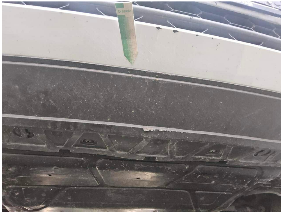
Bild 23 : Stoßfängerverkleidung vorne mehrfach verschrammt und deformiert
