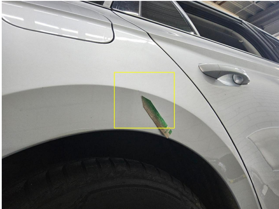
Bild 27 : Seitenwand rechts eingedellt mit Lackbeschädigung
