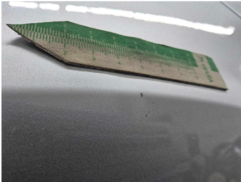
Bild 28 : Seitenwand rechts eingedellt mit Lackbeschädigung
