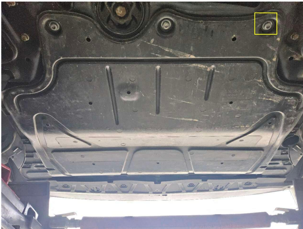
Bild 16 : Unterbodenverkleidung vorne gebrochen
