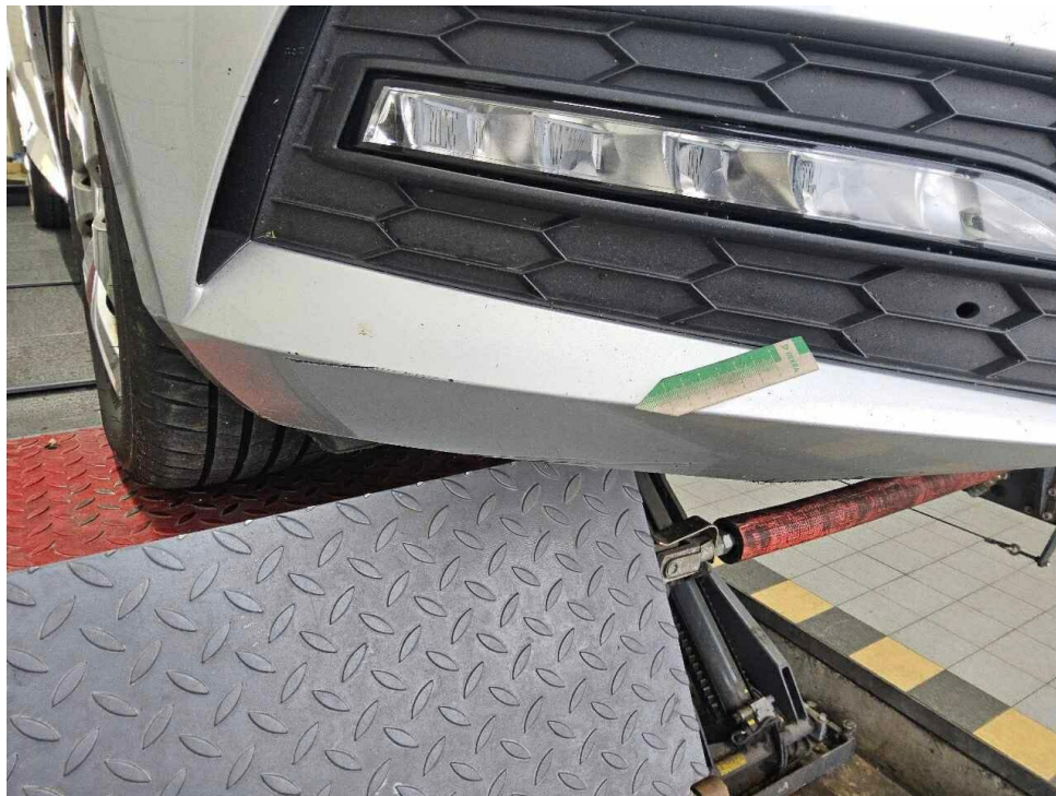
Bild 21 : Stoßfängerverkleidung vorne mehrfach verschrammt und deformiert
