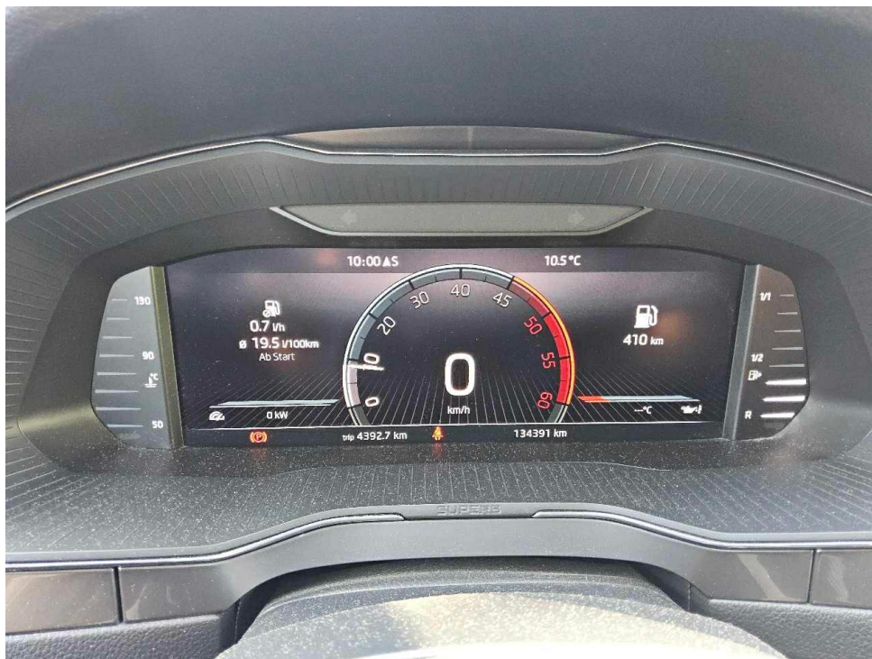
Bild 6 : Kombiinstrument (betriebsbereit) mit Km-Stand
