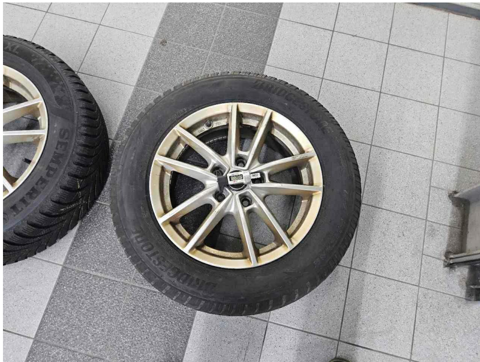
Bild 46 : Achse 1, Reifen Rechts <4mm Profiltiefe
