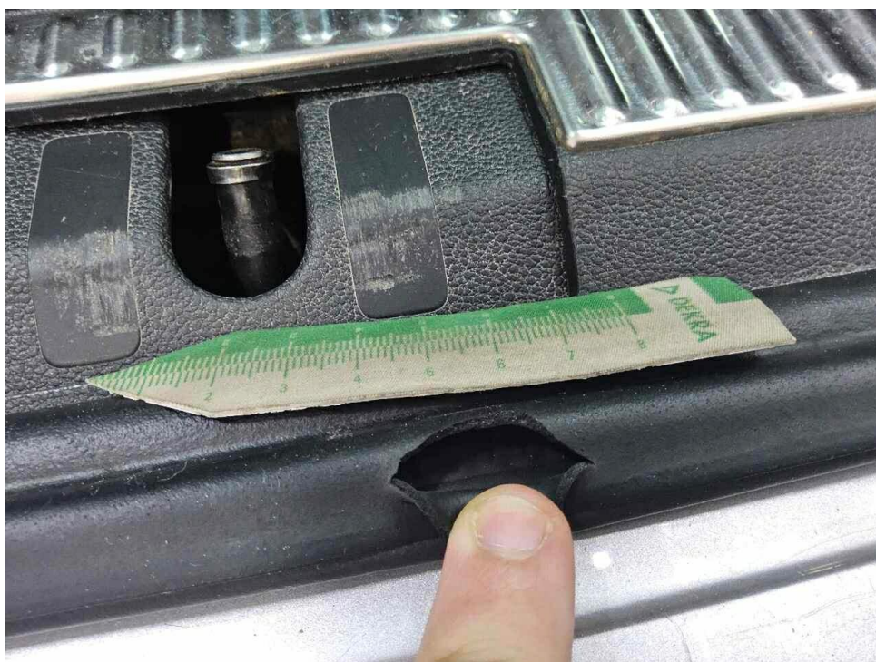
Bild 34 : Kofferraum Dichtung eingerissen
