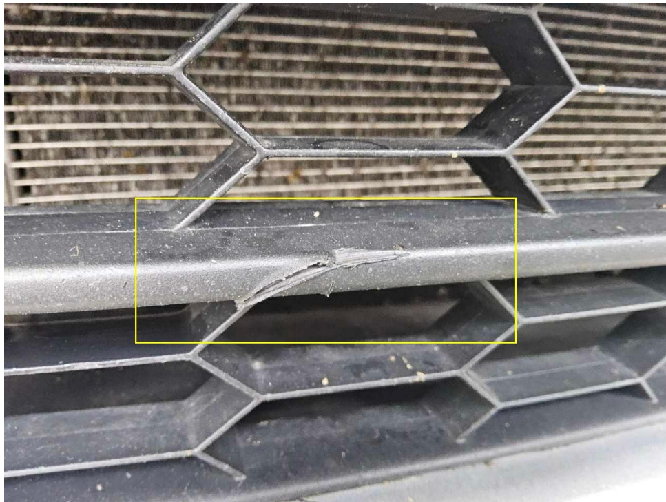
Bild 25 : Stoßfängerverkleidung vorne mehrfach verschrammt und deformiert
