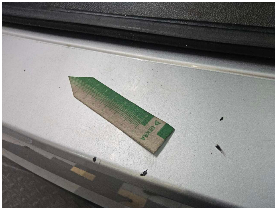
Bild 31 : Stoßfängerverkleidung hinten mehrfach verschrammt
