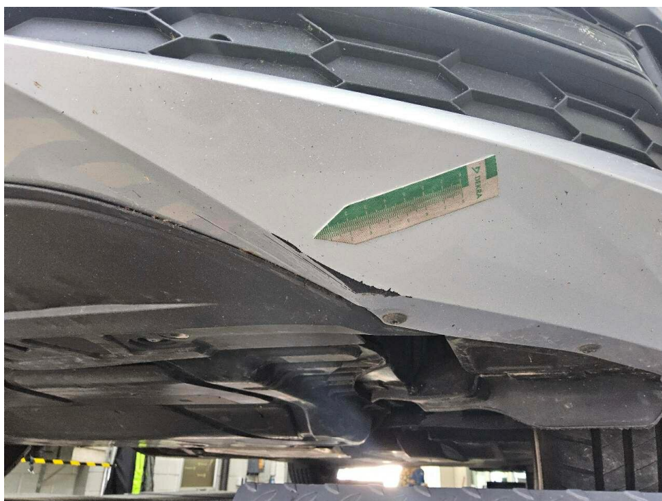
Bild 20 : Stoßfängerverkleidung vorne mehrfach verschrammt und deformiert
