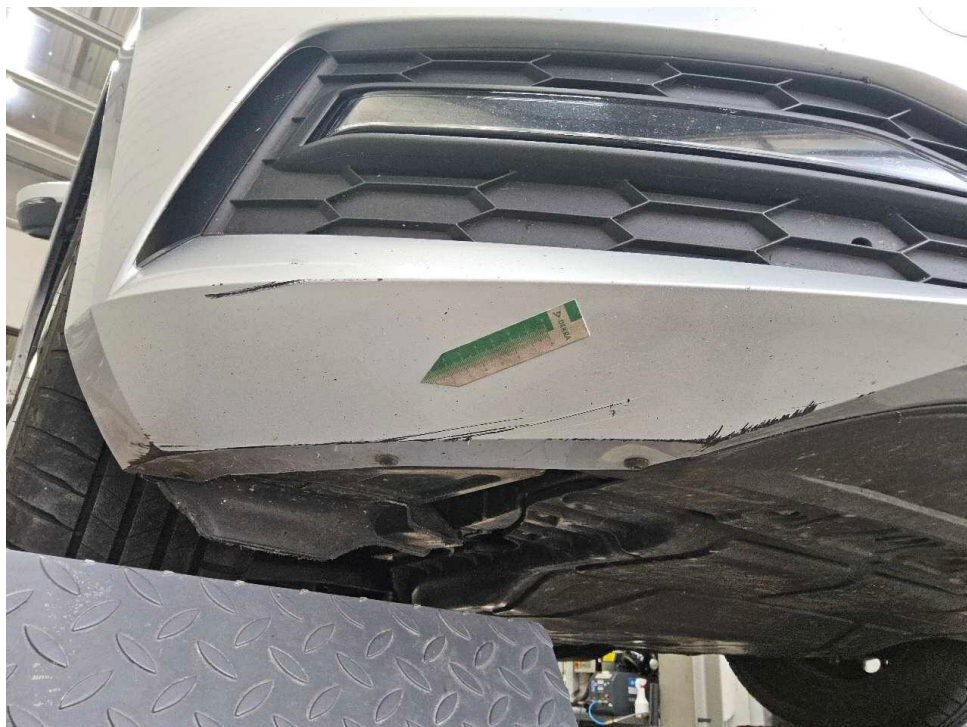
Bild 22 : Stoßfängerverkleidung vorne mehrfach verschrammt und deformiert
