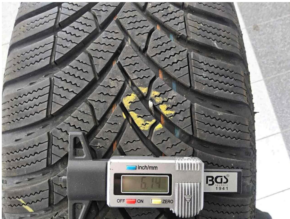
Bild 48 : Achse 1, Reifen Links Fremdkörper
