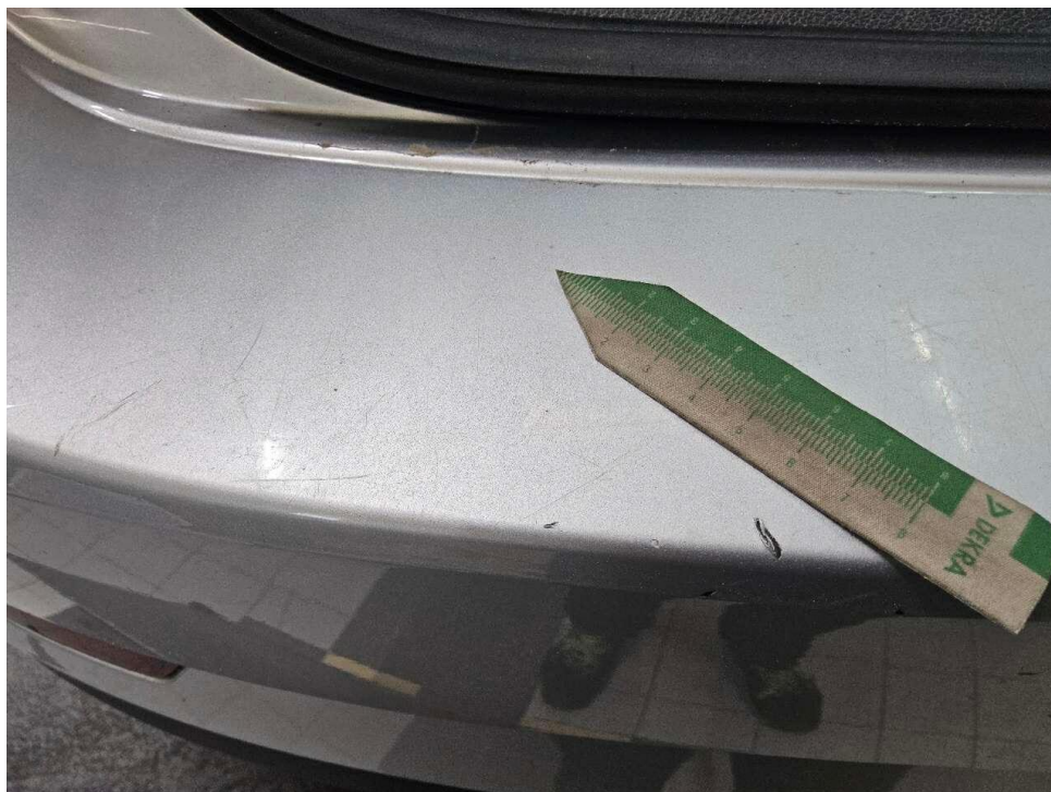
Bild 32 : Stoßfängerverkleidung hinten mehrfach verschrammt
