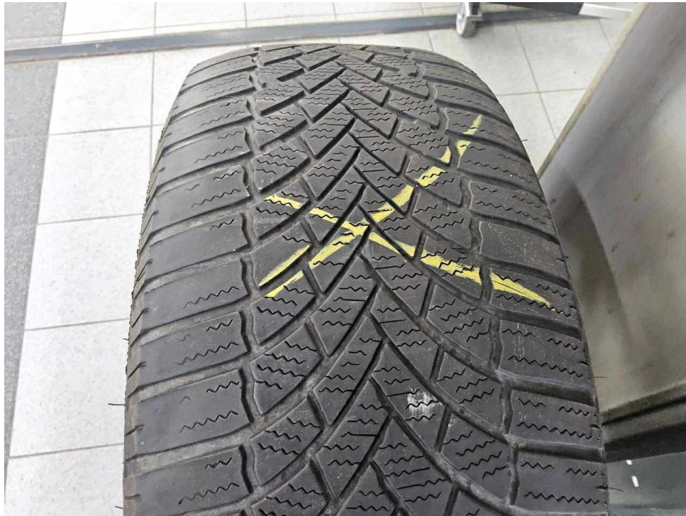
Bild 47 : Achse 1, Reifen Rechts <4mm Profiltiefe
