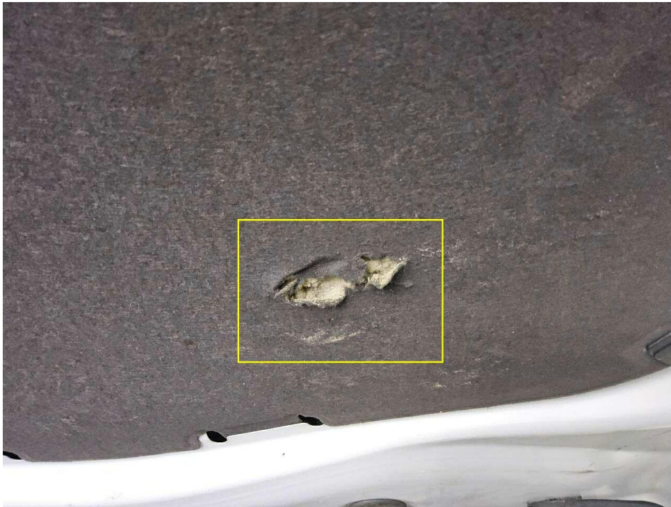
Bild 15 : Motorhaube Dämmmatte Nagetierschaden
