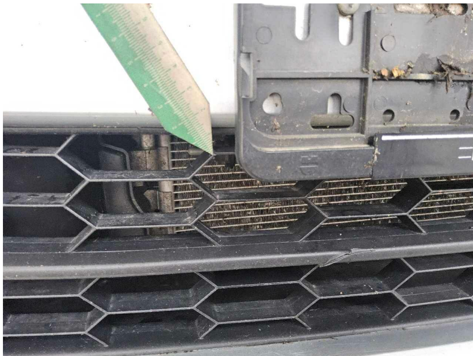
Bild 24 : Stoßfängerverkleidung vorne mehrfach verschrammt und deformiert
