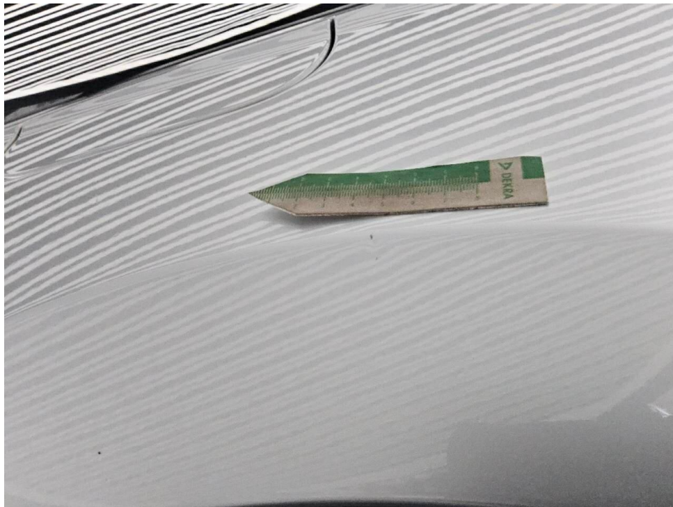
Bild 29 : Seitenwand rechts eingedellt mit Lackbeschädigung
