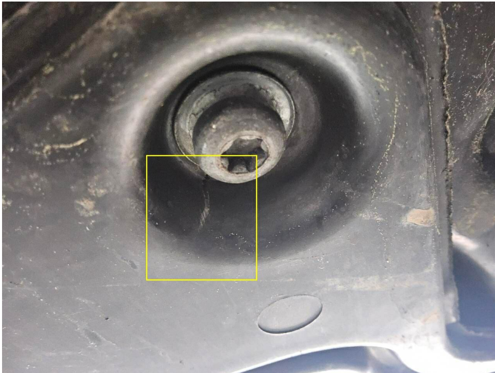
Bild 17 : Unterbodenverkleidung vorne gebrochen
