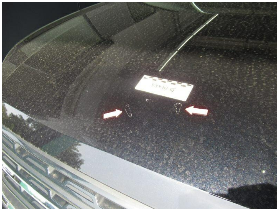
Bild 15 : Motorhaube Lackierung, Umweltschaden, lackieren mit Lackaufbau
