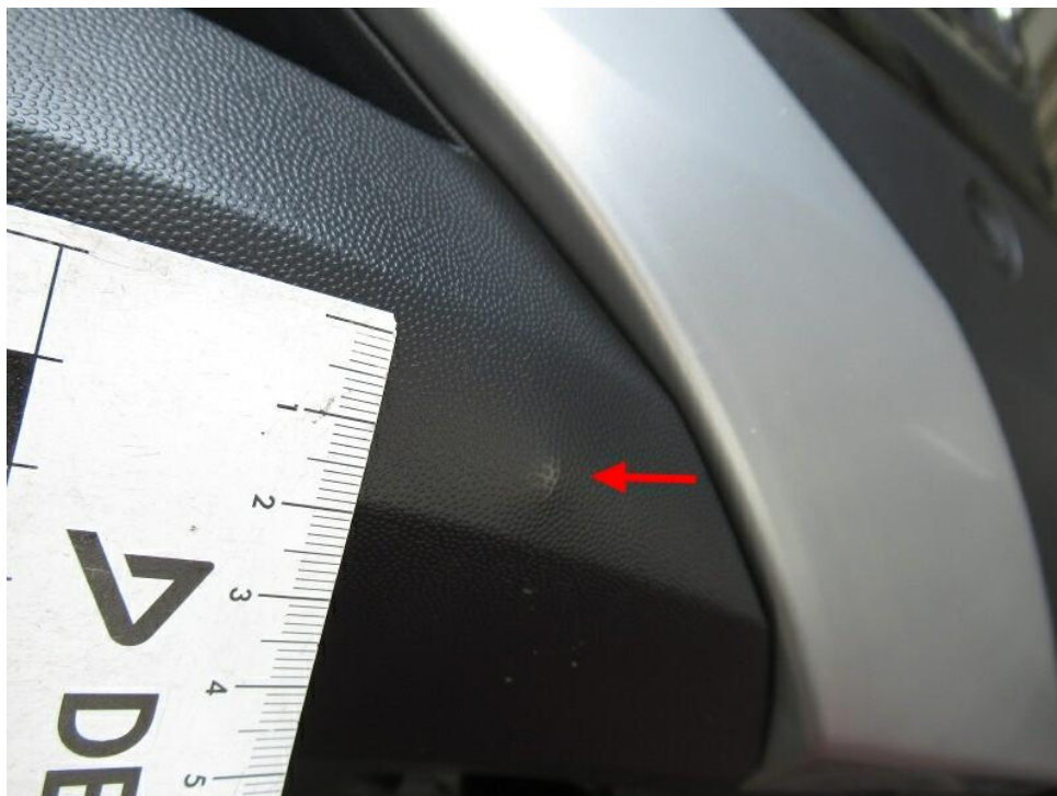
Bild 14 : Stoßfänger vorne, Spoiler deformiert
