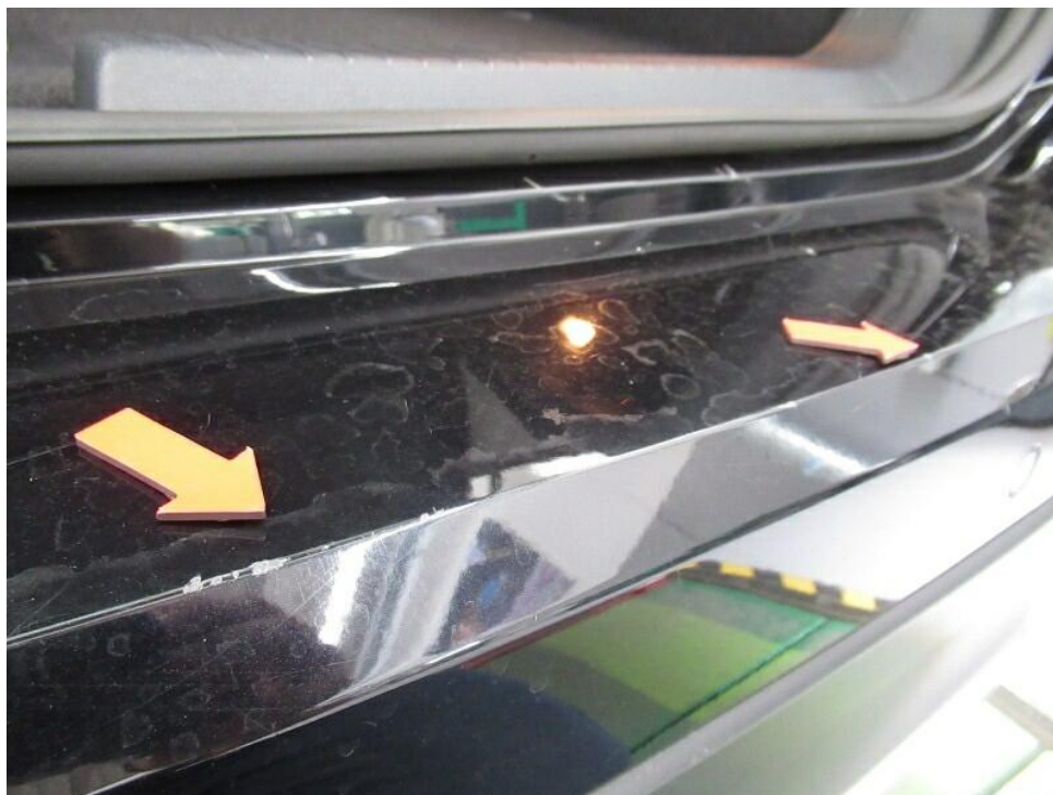
Bild 19 : Stoßfänger hinten Lackierung, zerkratzt, lackieren mit Lackaufbau
