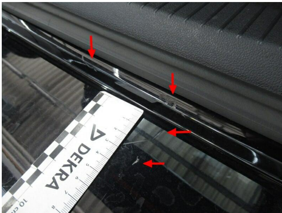
Bild 22 : Stoßfänger hinten Lackierung, zerkratzt, lackieren mit Lackaufbau
