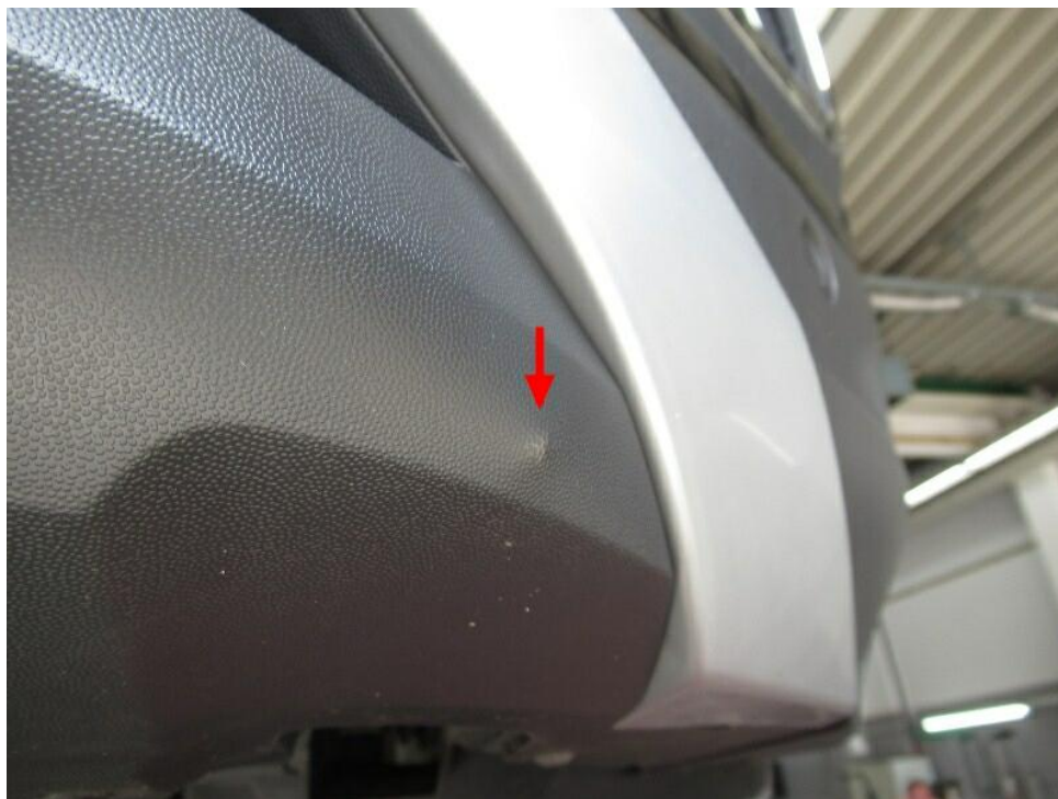
Bild 13 : Stoßfänger vorne, Spoiler deformiert
