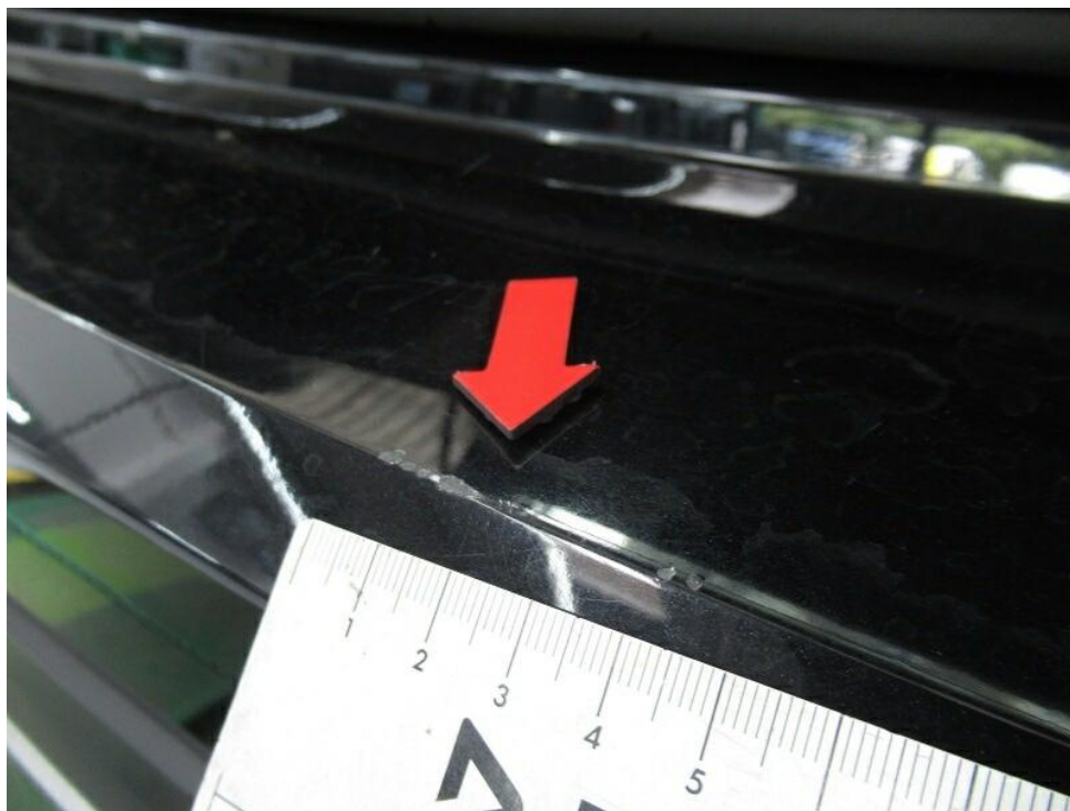
Bild 20 : Stoßfänger hinten Lackierung, zerkratzt, lackieren mit Lackaufbau
