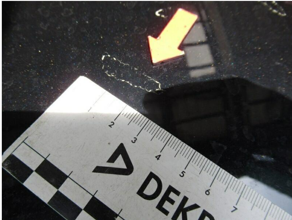
Bild 17 : Motorhaube Lackierung, Umweltschaden, lackieren mit Lackaufbau
