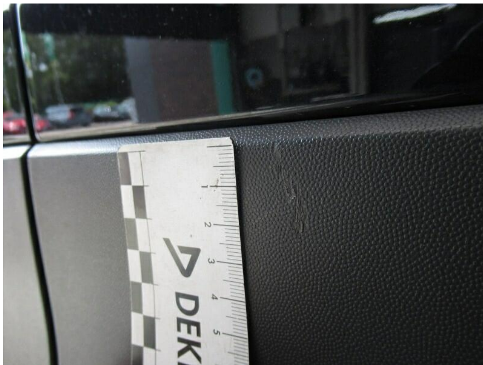
Bild 27 : Tür hinten links, Zierblende zerkratzt
