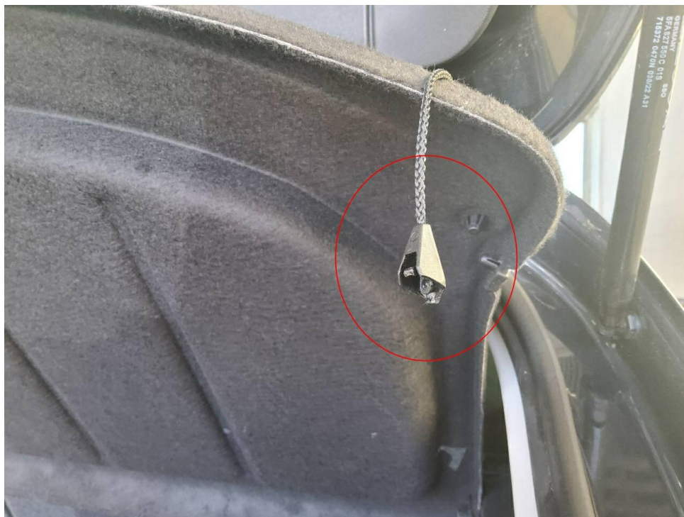
Bild 15 : Gepäckraumabdeckung, Befestigung abgebrochen
