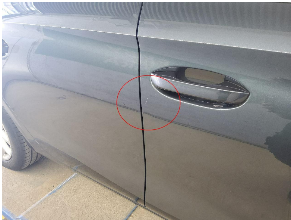
Bild 16 : Tür vorne rechts Lackierung unterhalb, zerkratzt, lackieren mit Lackaufbau
