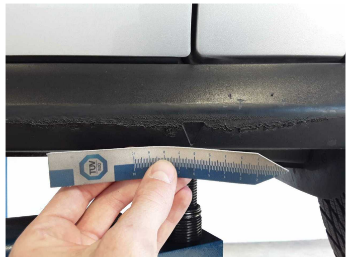
Damage 3: Sill - left side: Trim - Scratch(es) - Replace
