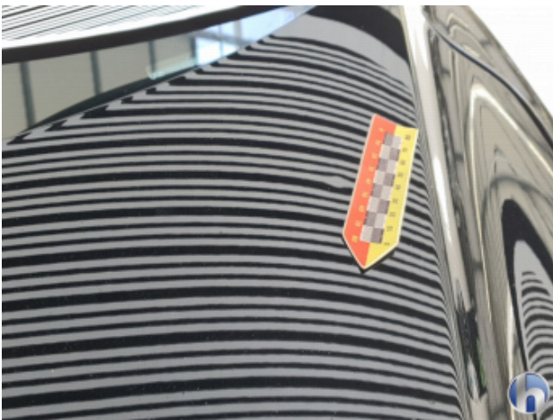
2. Motorhaube Dellen / Beulen - Sanft Instandsetzen
