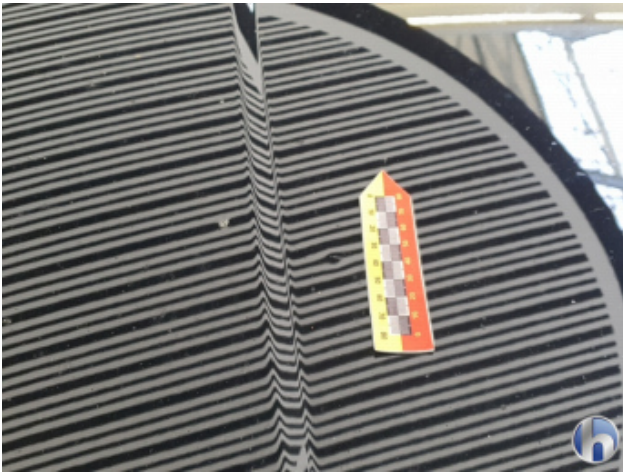
2. Motorhaube Dellen / Beulen - Sanft Instandsetzen
