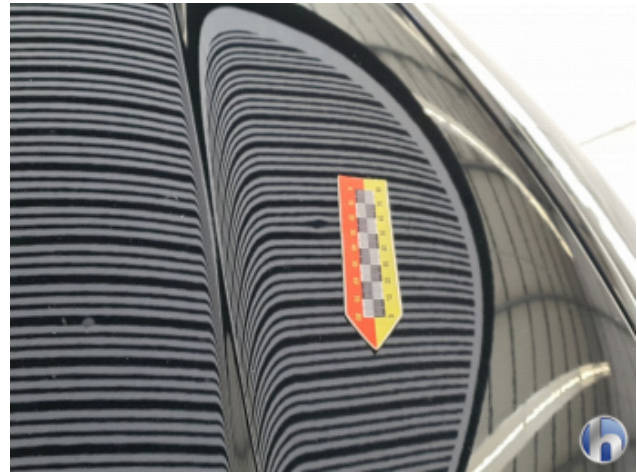
2. Motorhaube Dellen / Beulen - Sanft Instandsetzen
