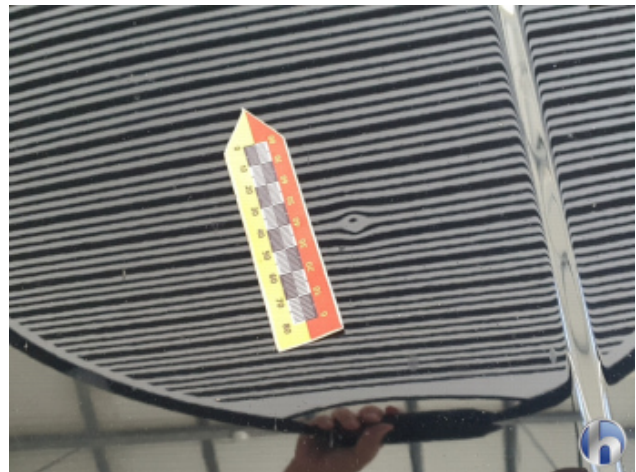
2. Motorhaube Dellen / Beulen - Sanft Instandsetzen
