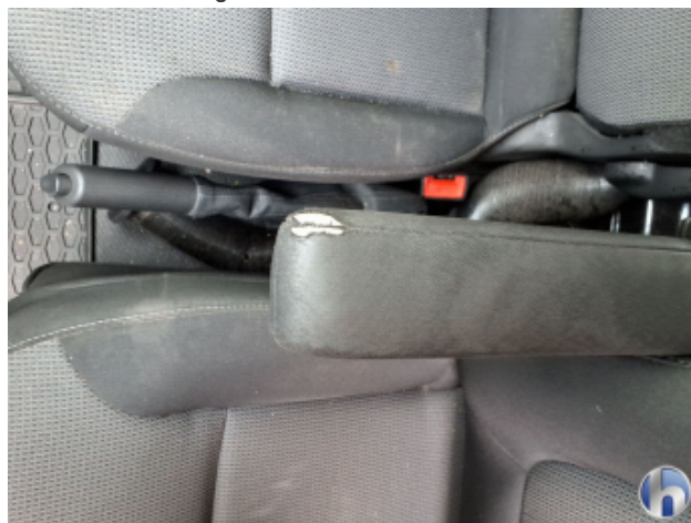
7. Sitz Innenraum links vorne Beschädigt - Erneuern
