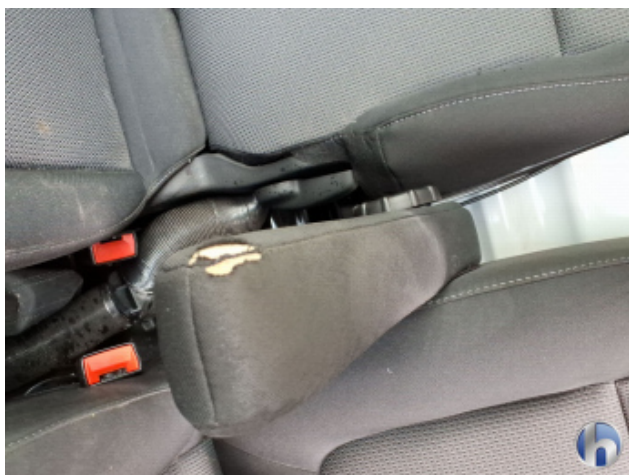
7. Sitz Innenraum links vorne Beschädigt - Erneuern
