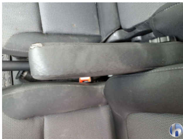
7. Sitz Innenraum links vorne Beschädigt - Erneuern
