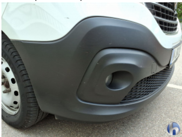
2. Stoßfänger Vorne Gebrauchsspuren - Ohne Reparatur
