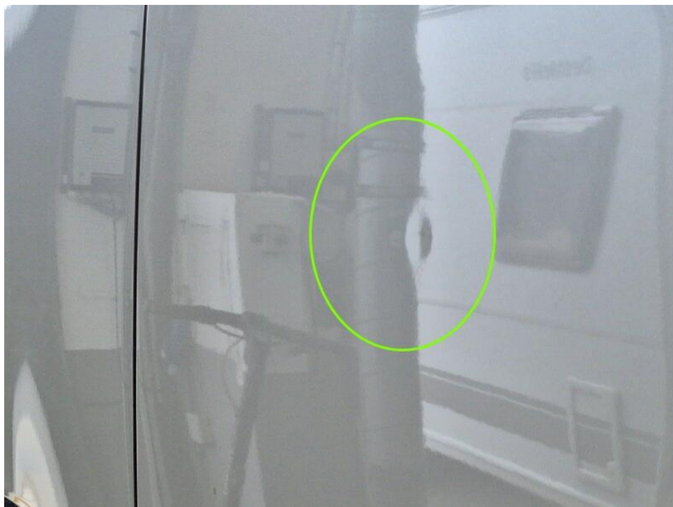
Bild 16 : Tür vorne rechts eingedellt
