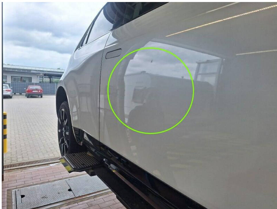
Bild 15 : Tür vorne rechts eingedellt
