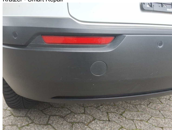
Beschädigung #5: Stossfänger hinten: Stossfänger hinten - Kratzer - lackieren
