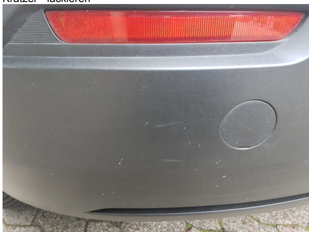
Beschädigung #5: Stossfänger hinten: Stossfänger hinten - Kratzer - lackieren
