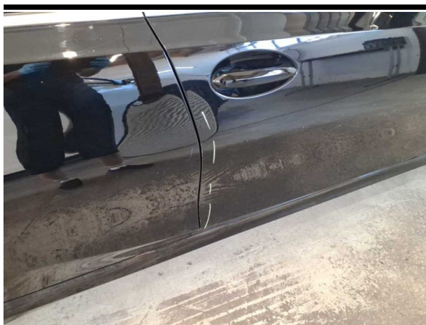
Beschädigung #5: Tür vorn rechts: Türkante - verkratzt / verschü... - Smart Repair
