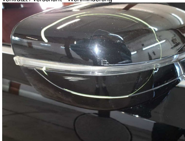
Beschädigung #4: Außenspiegel rechts: Abdeckkappe - verkratzt / verschürft - Smart Repair
