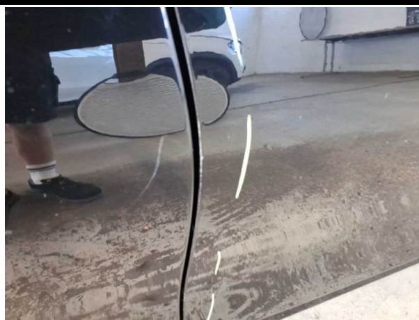
Beschädigung #5: Tür vorn rechts: Türkante - verkratzt / verschürft - Smart Repair
