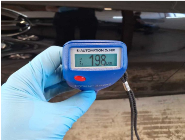
Nachlackierung 1: Dach, Seitenwand rechts, Tür hinten rechts
