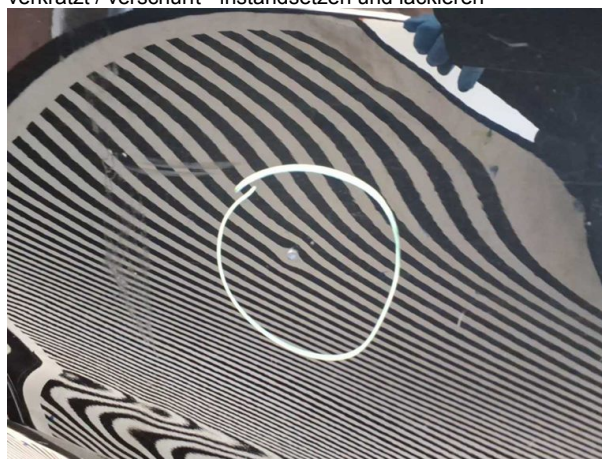
Beschädigung #9: Tür hinten links: Tür - Delle / Lackschade... instandsetzen und lackieren
