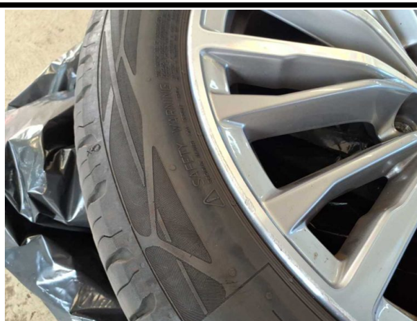
Beschädigung #7: 2.Radsatz: 2 Leichtmetallfelgen - verkratzt... verschürft - Wertminderung
