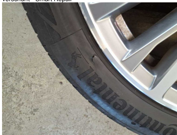
Beschädigung #6: 2.Radsatz: 1 Reifen - beschädigt - erneuern
