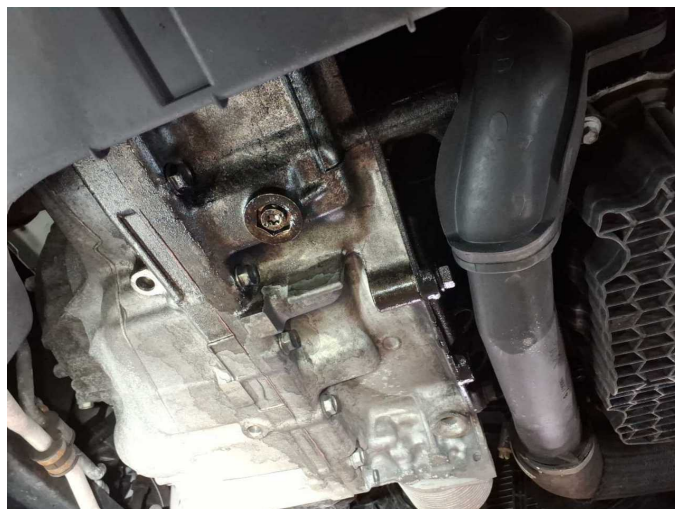
Damage 11: Engine: Engine (+ Getriebe, Umweltbelastung) - Leaking - Perform diagnosis
