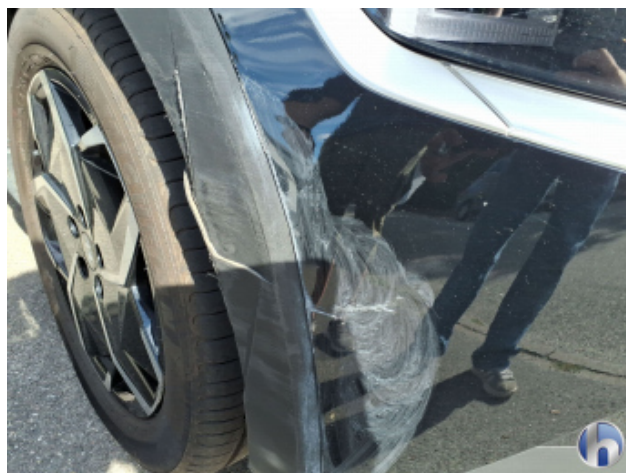
6. Kotflügel Vorne - Rechts Unfallschaden - Erneuern
