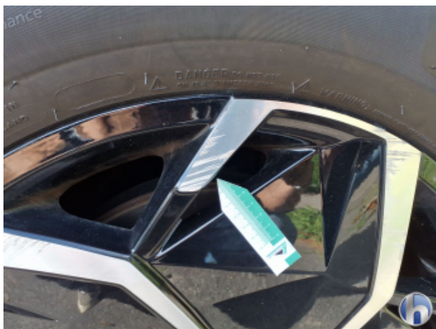
2. Felge Hinten - Links Kratzer - Erneuern
