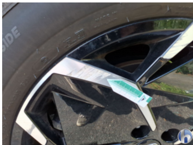
2. Felge Hinten - Links Kratzer - Erneuern
