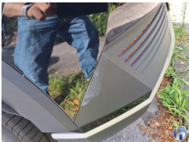
3. Stoßfänger Hinten Beschädigt - Erneuern
