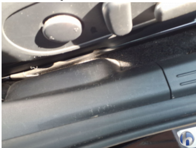
11. Verkleidung Verschmutzt - Reinigen
