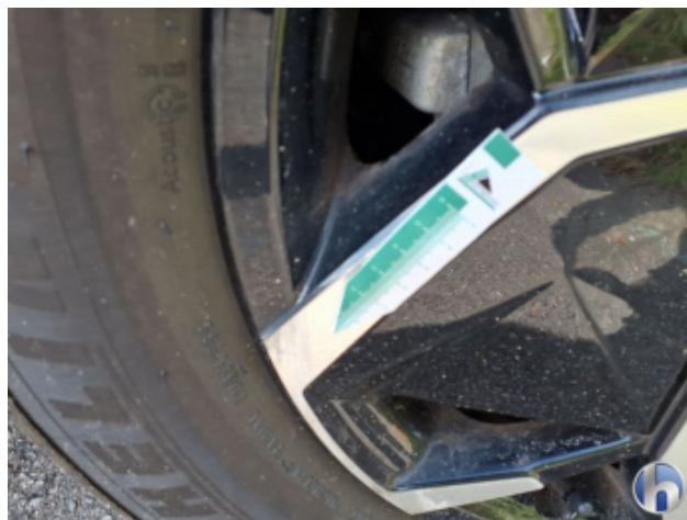
2. Felge Hinten - Links Kratzer - Erneuern
