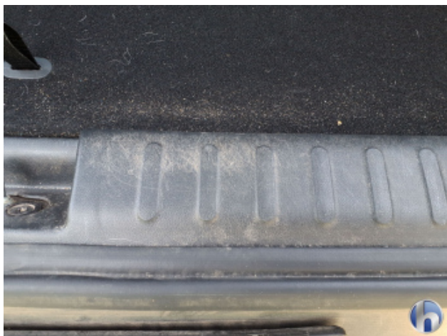
9. Heckdeckelverkleidung Beschädigt - Erneuern
