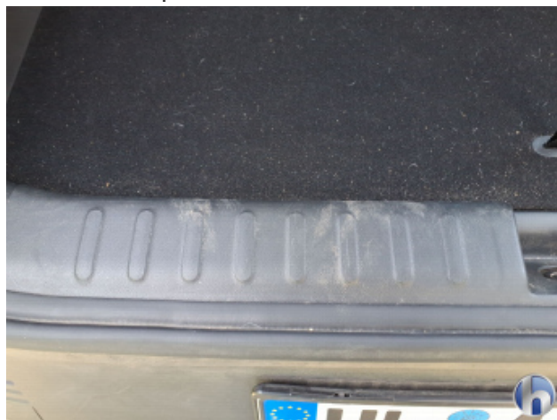
9. Heckdeckelverkleidung Beschädigt - Erneuern
