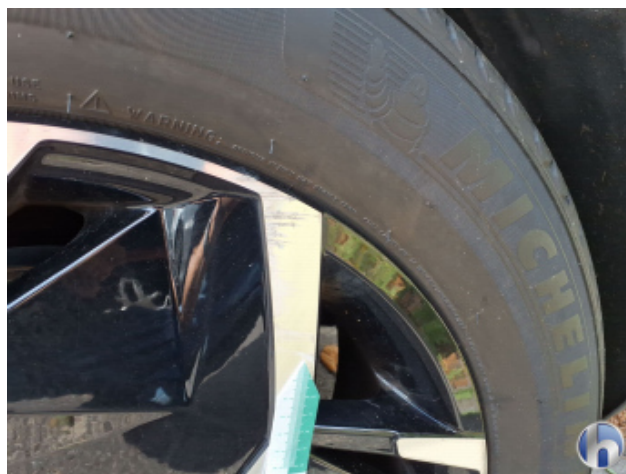
2. Felge Hinten - Links Kratzer - Erneuern
