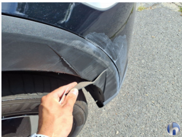
6. Kotflügel Vorne - Rechts Unfallschaden - Erneuern
