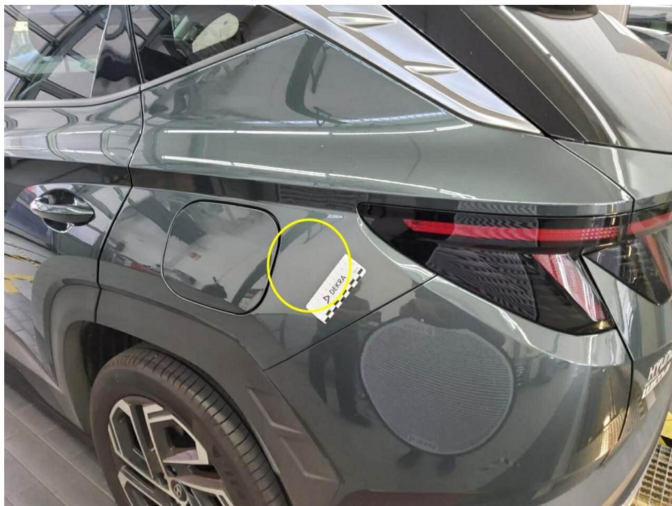
Bild 14 : Seitenteil hinten links, eingedellt, smart repair
