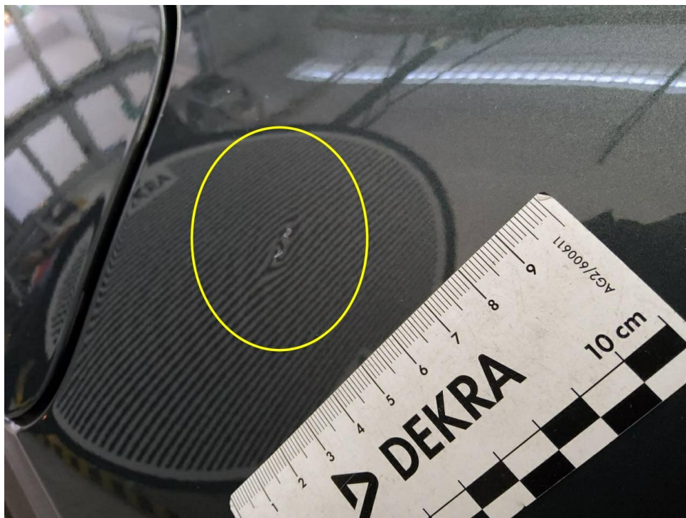
Bild 13 : Seitenteil hinten links, eingedellt, smart repair
