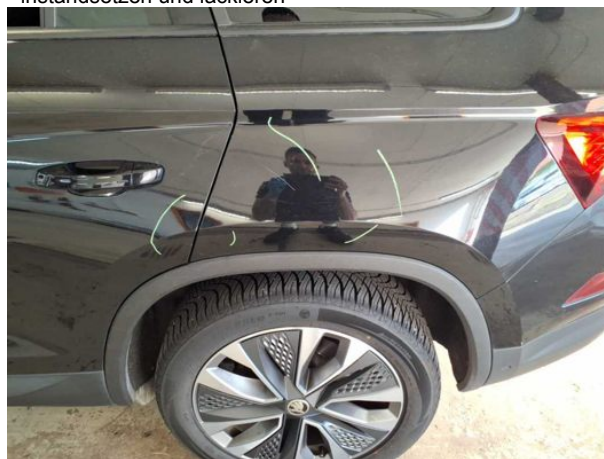
Beschädigung #11: Seitenwand links: Seitenwand - verkratzt / verschürft - instandsetzen und lackieren
