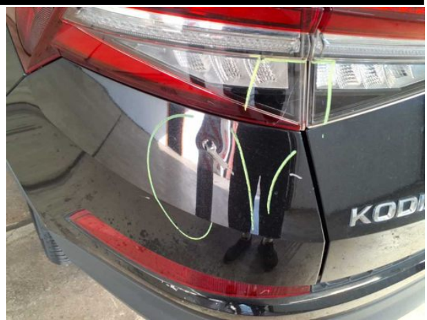
Beschädigung #14: Stossfänger hinten: Stossfänger hinten - beschädigt - erneuern
