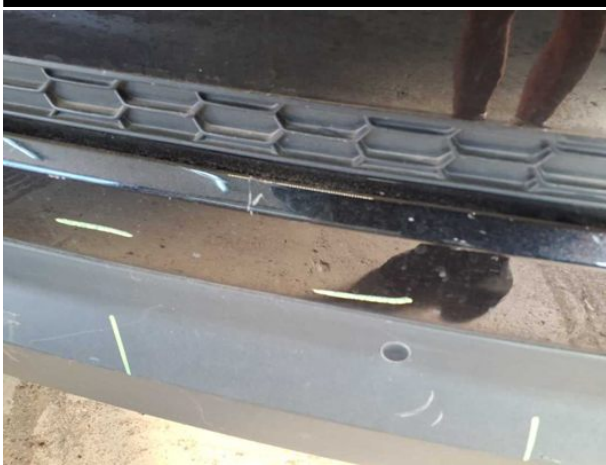
Beschädigung #14: Stossfänger hinten: Stossfänger hinten - beschädigt - erneuern
