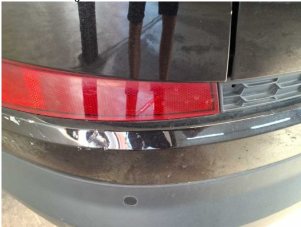
Beschädigung #6: Heckklappe/-tür: Reflektoren - beschädigt - erneuern
