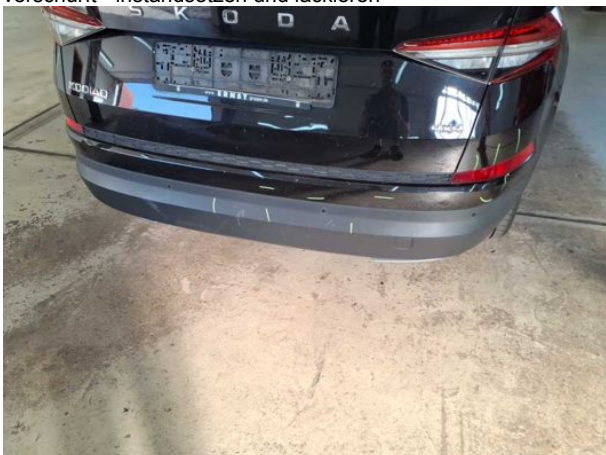
Beschädigung #14: Stossfänger hinten: Stossfänger hinten - beschädigt - erneuern
