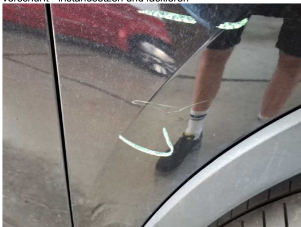
Beschädigung #8: Kotflügel rechts: Kotflügel rechts - verkratzt / verschürft - instandsetzen und lackieren
