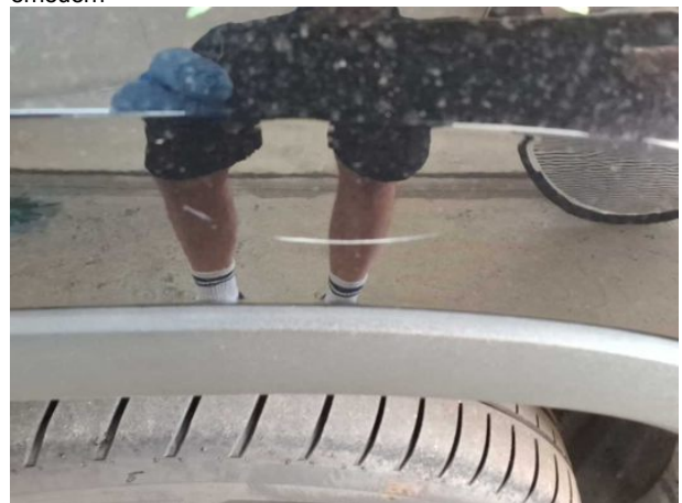
Beschädigung #7: Kotflügel links: Kotflügel links - verkratzt / verschürft - instandsetzen und lackieren
