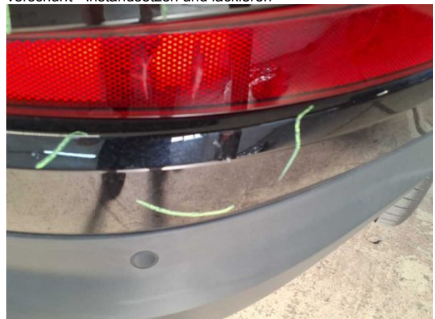
Beschädigung #14: Stossfänger hinten: Stossfänger hinten - beschädigt - erneuern
