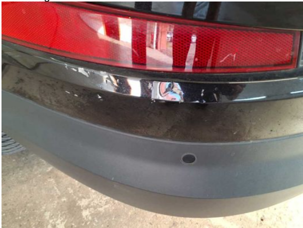
Beschädigung #14: Stossfänger hinten: Stossfänger hinten - beschädigt - erneuern
