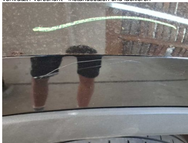
Beschädigung #8: Kotflügel rechts: Kotflügel rechts - verkratzt / verschürft - instandsetzen und lackieren
