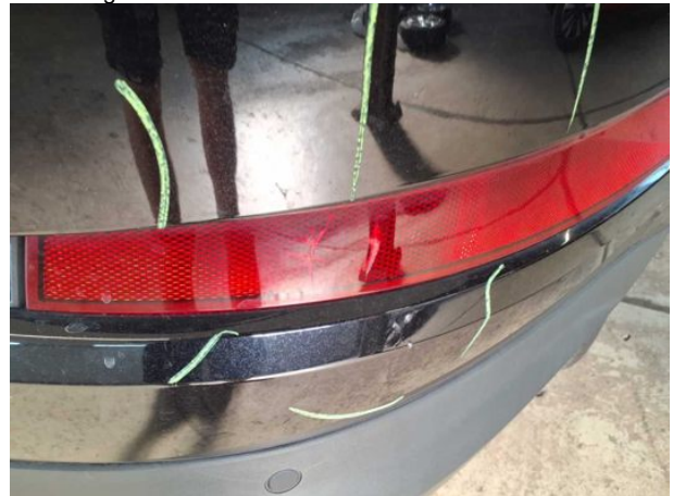
Beschädigung #6: Heckklappe/-tür: Reflektoren - beschädigt - erneuern
