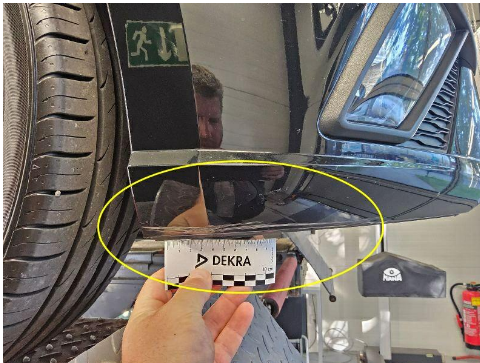
Bild 22 : Stoßfänger vorne verformt und verschrammt mit Materialabtrag
