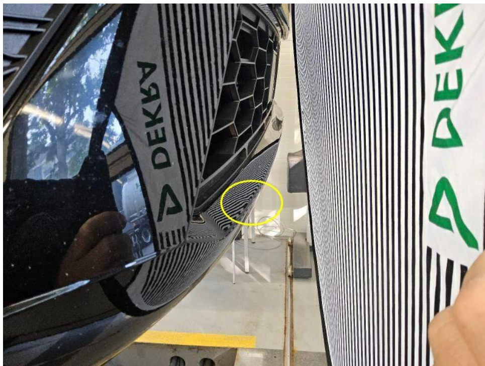
Bild 24 : Stoßfänger vorne verformt und verschrammt mit Materialabtrag
