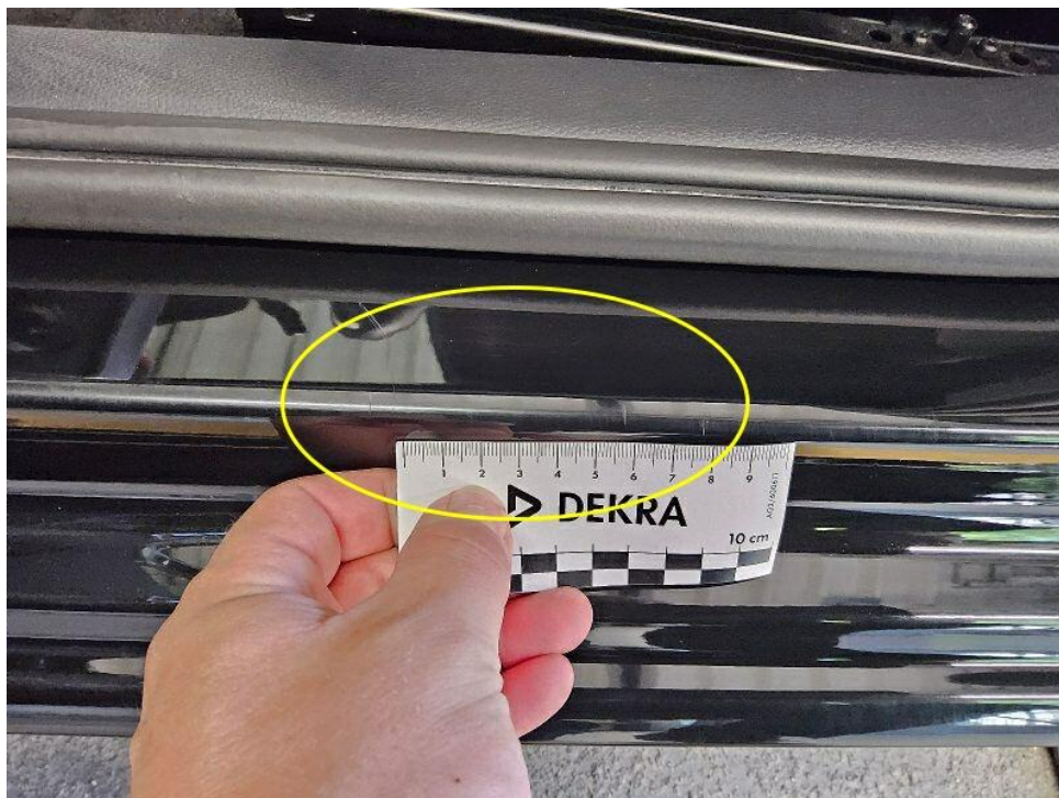
Bild 14 : Einstieg vorne links zerkratzt
