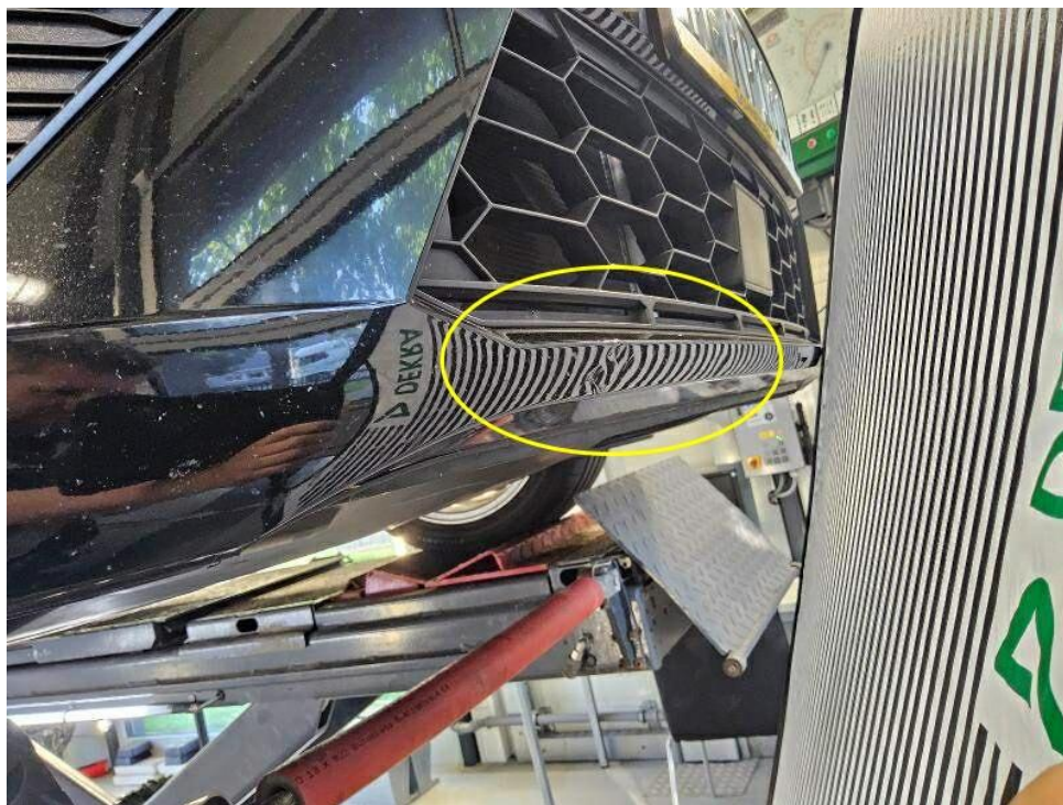
Bild 23 : Stoßfänger vorne verformt und verschrammt mit Materialabtrag
