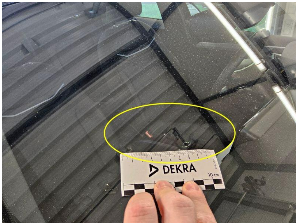
Bild 20 : Diverse Steinschläge im Frontbereich
