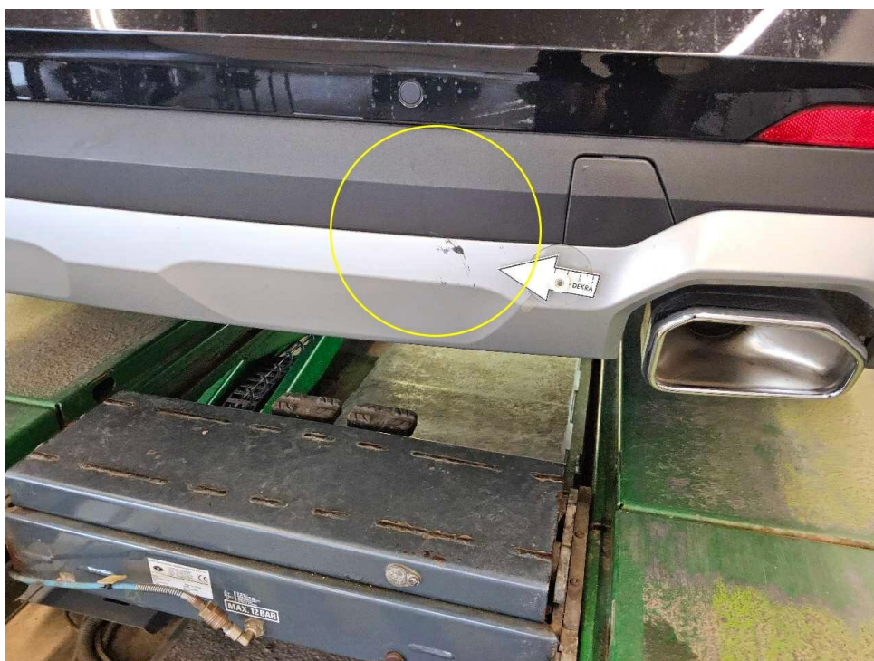
Bild 17 : Heckschaden (Stoßfänger hinten Unterteil), verschrammt
