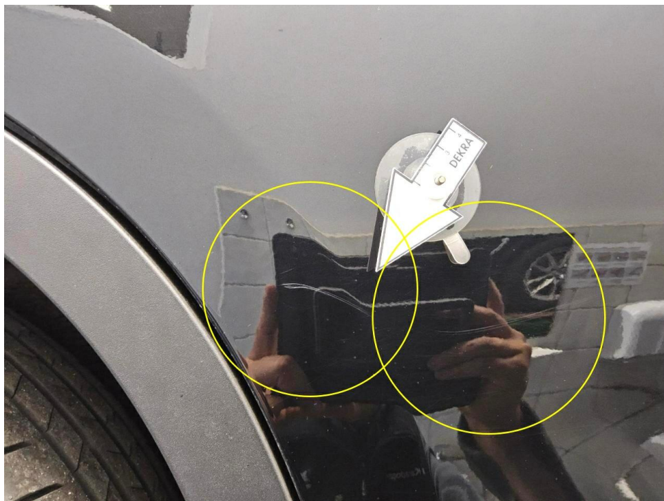
Bild 16 : Tür hinten rechts Lackierung, zerkratzt, polieren
