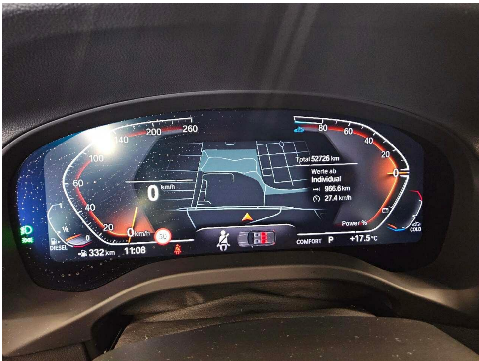
Bild 6 : Kombiinstrument (betriebsbereit) mit Km-Stand
