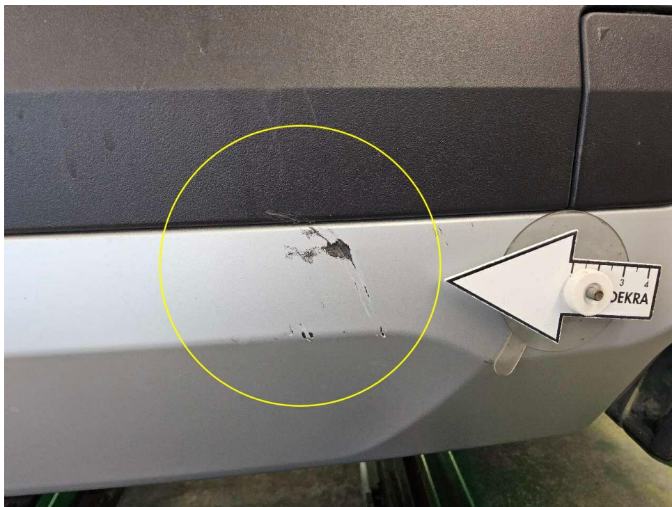
Bild 18 : Heckschaden (Stoßfänger hinten Unterteil), verschrammt
