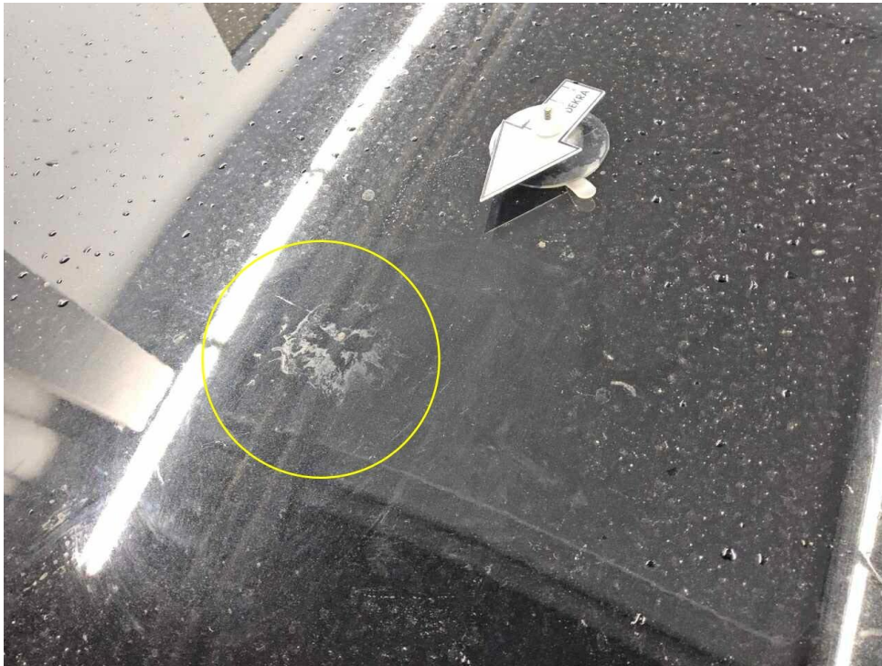
Bild 14 : Motorhaube Lackierung, Umweltschaden, polieren
