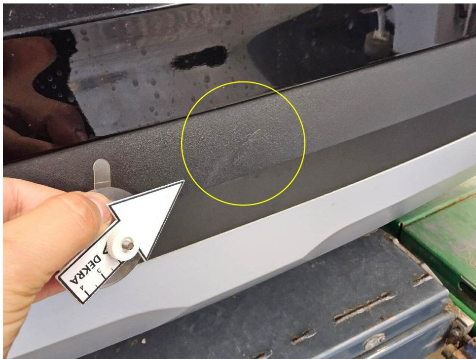
Bild 19 : Heckschaden (Stoßfänger hinten Unterteil), verschrammt
