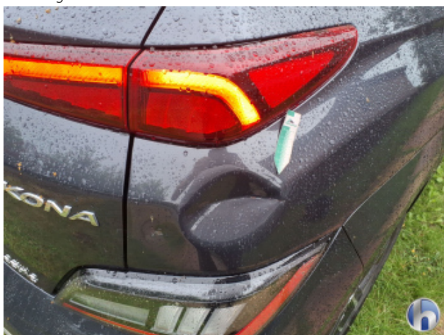
1. Seitenwand - Hinten - Rechts Beschädigt - Instandsetzen und Lackieren
