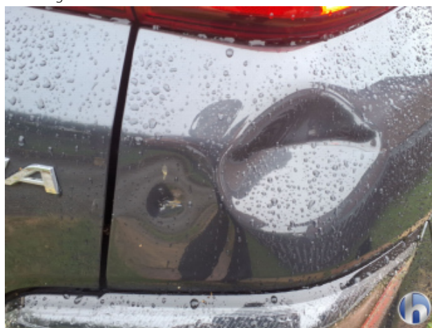
1. Seitenwand - Hinten - Rechts Beschädigt - Instandsetzen und Lackieren
