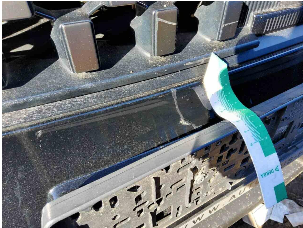
Bild 13 : Stoßfänger vorne Lackierung, zerkratzt, lackieren mit Lackaufbau
