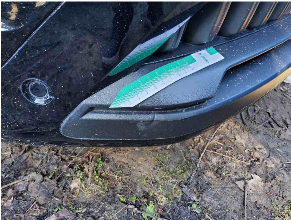
Bild 12 : Blende Stoßfänger vorne rechts, deformiert
