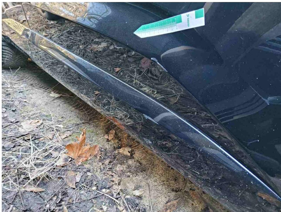
Bild 20 : Tür vorne rechts, deformiert, instandsetzen und lackieren mit Lackaufbau
