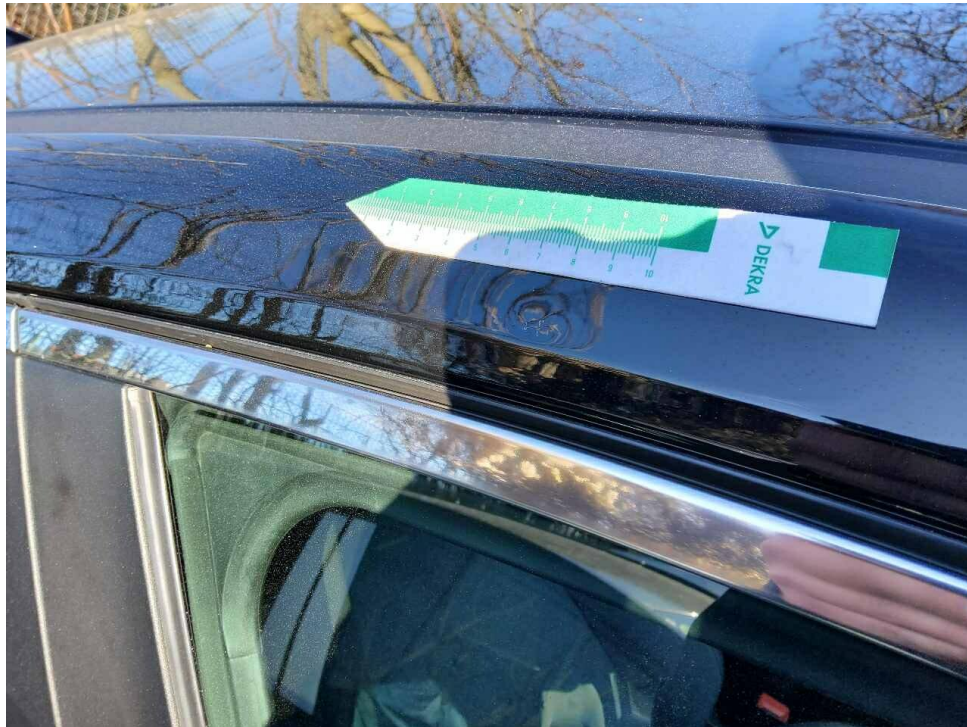
Bild 19 : Dachrahmen rechts, deformiert, instandsetzen und lackieren mit Lackaufbau
