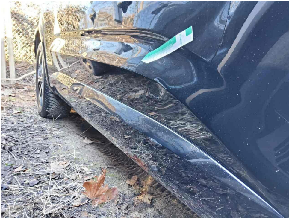
Bild 21 : Tür vorne rechts, deformiert, instandsetzen und lackieren mit Lackaufbau
