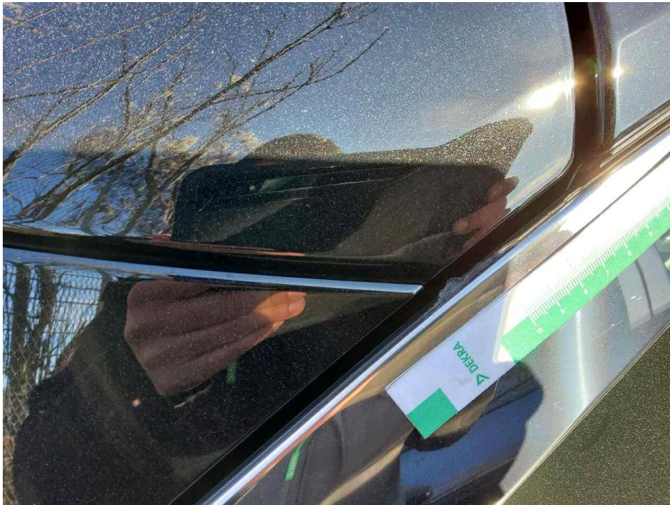
Bild 17 : Dichtung Seitenscheibe hinten rechts, beschädigt
