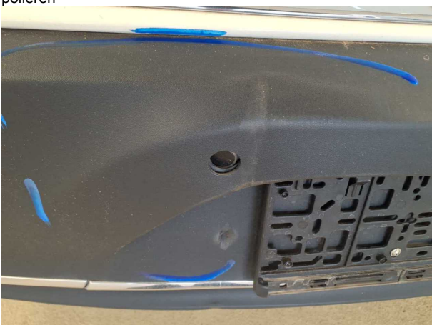
Beschädigung #5: Stossfänger hinten: Parksensoren Mitte - beschädigt - erneuern
