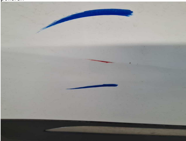
Beschädigung #2: Tür hinten rechts: Tür - Abrieb - auslegen / polieren
