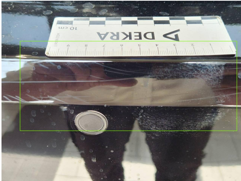
Bild 17 : Stoßfänger hinten Kratzer
