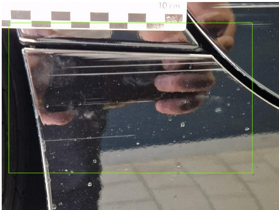
Bild 22 : Schwellerverkleidung rechts zerkratzt
