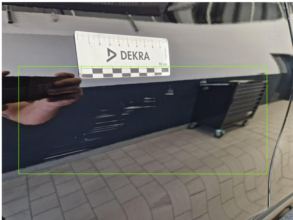
Bild 20 : Tür hinten rechts zerkratzt
