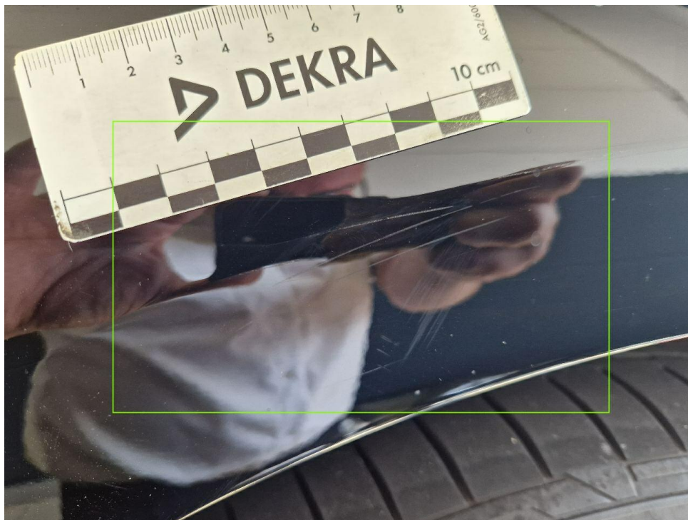
Bild 15 : Seitenwand hinten links Kratzer
