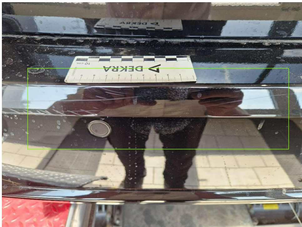
Bild 16 : Stoßfänger hinten Kratzer
