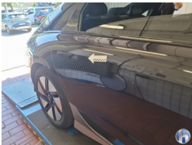
3. Tür Hinten - Rechts 1 Delle - Sanft Instandsetzen
