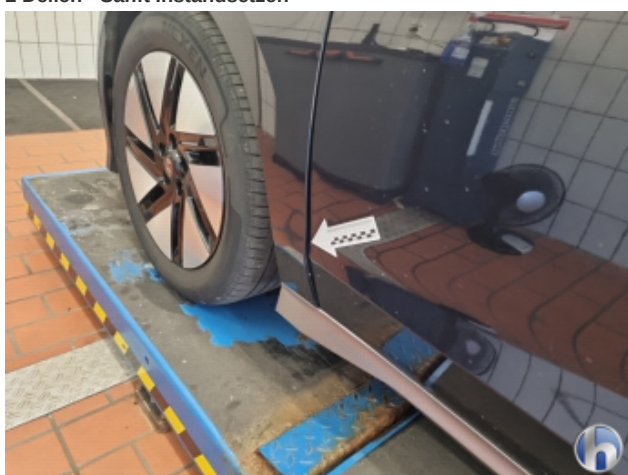
2. Kotflügel Vorne - Links Spaltmaß Ungenau - Nacharbeiten
