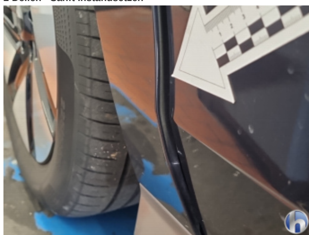
2. Kotflügel Vorne - Links Spaltmaß Ungenau - Nacharbeiten
