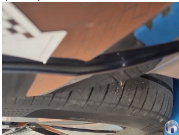
2. Kotflügel Vorne - Links Spaltmaß Ungenau - Nacharbeiten
