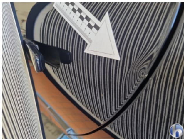
4. Tür Hinten - Links Beschädigt - Smart Repair
