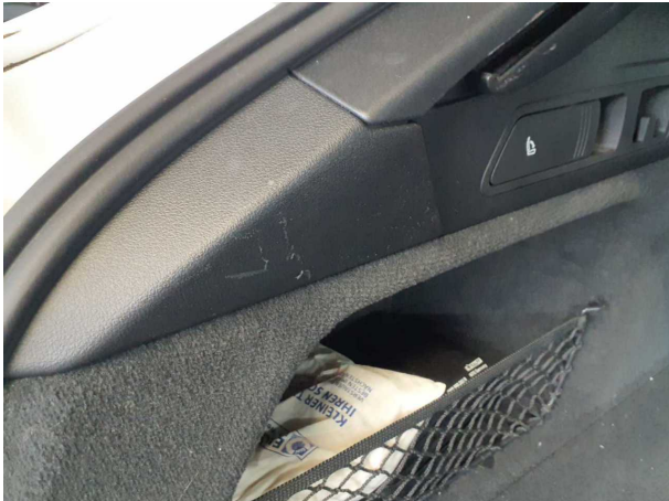
Beschädigung #1: Verkleidungen/Abdeckungen: Verkleidungen/Abdeckungen - verkratzt / verschürft - Wertminderung
