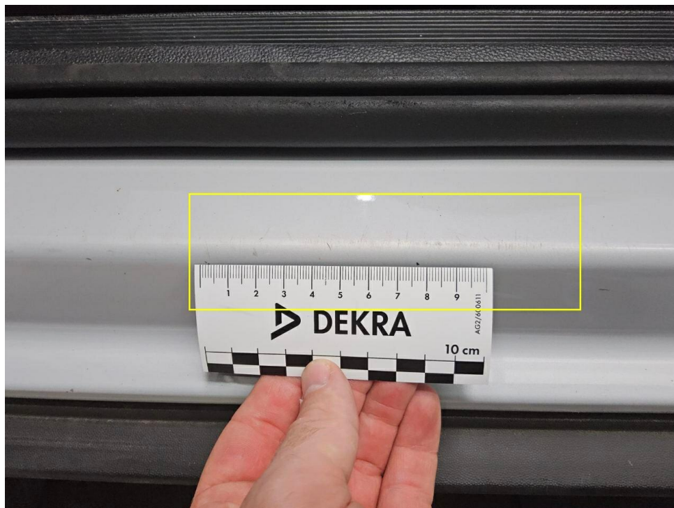
Bild 18 : Tür vorne links Einstieg Lackierung, zerkratzt, Gebrauchsspur
