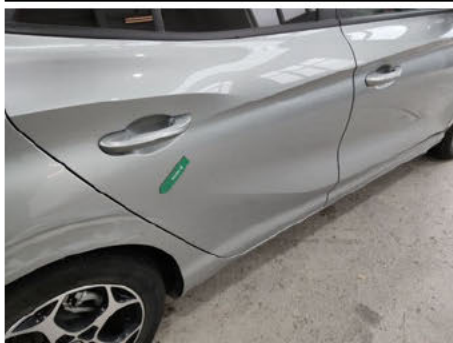
Tür / Hinten Rechts / Delle
