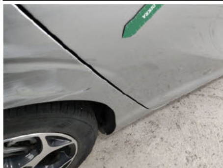
Tür / Hinten Rechts / Delle
