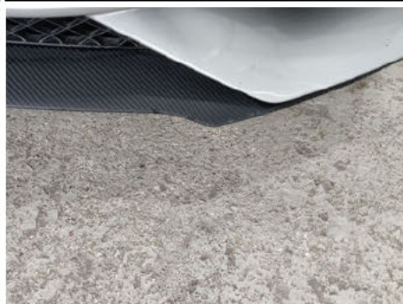
Spoiler / Vorne / Gebrochen
