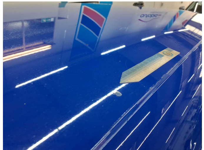
Damage 5: Roof: Roof (Verätzungen) - Paint defect - Paint
