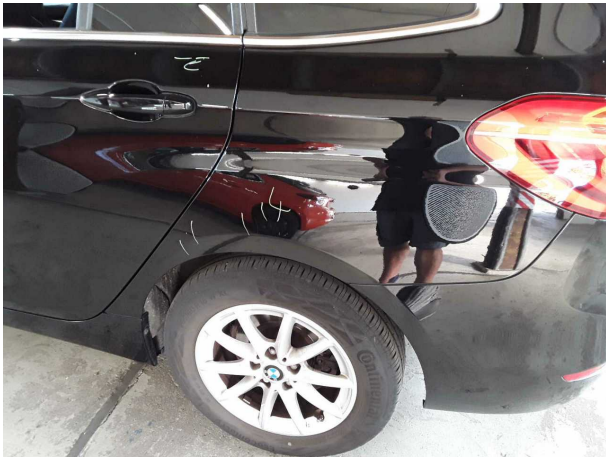
Beschädigung #7: Seitenwand links: Seitenwand - verkratzt / verschürft - lackieren
