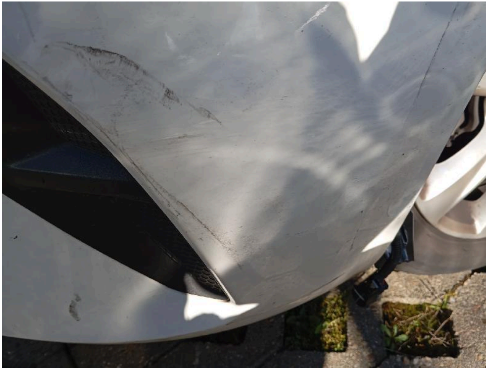
Bild: 15 Stoßfänger vorne verschrammt
