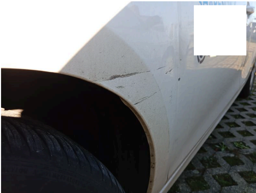
Bild: 21 Kotflügel links verformt
