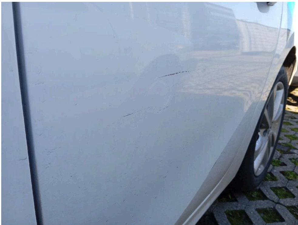
Bild: 28 Tür hinten links verschrammt
