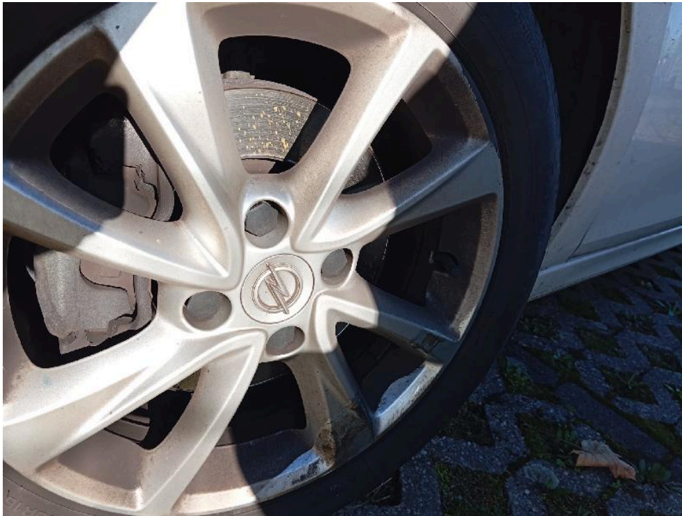
Bild: 17 Rad vorne links verschrammt und Fehlstellung
