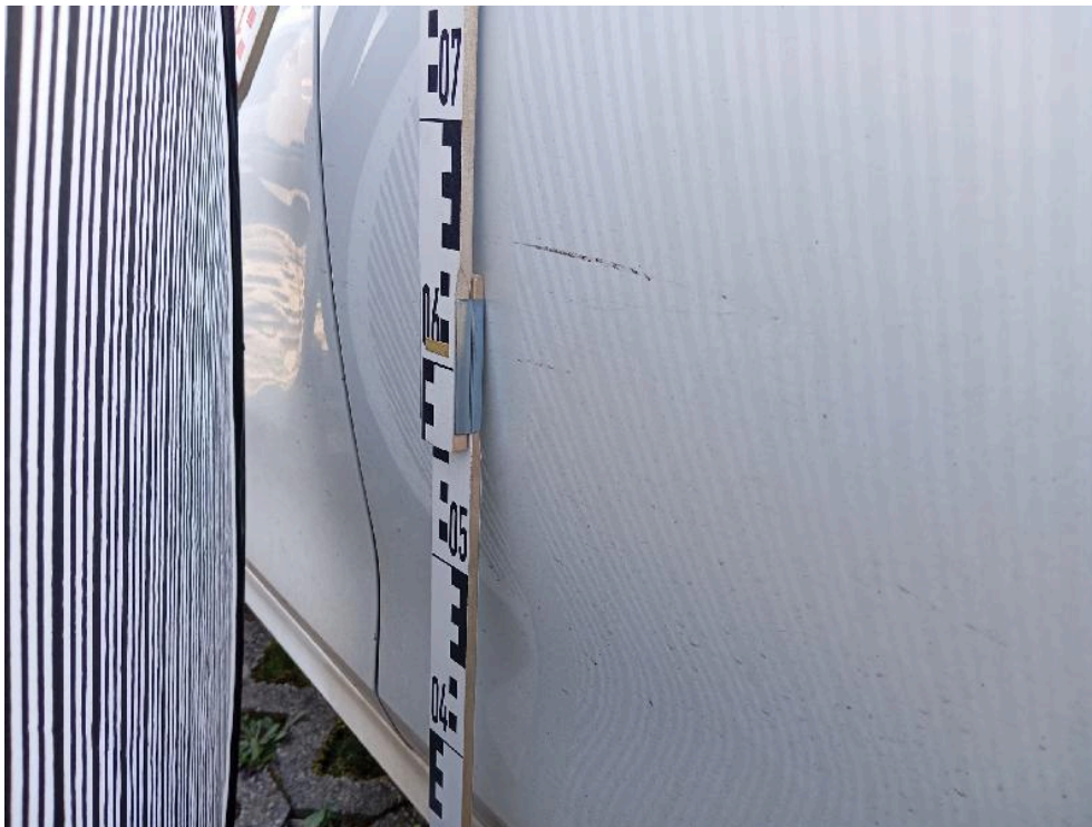
Bild: 29 Tür hinten links verschrammt
