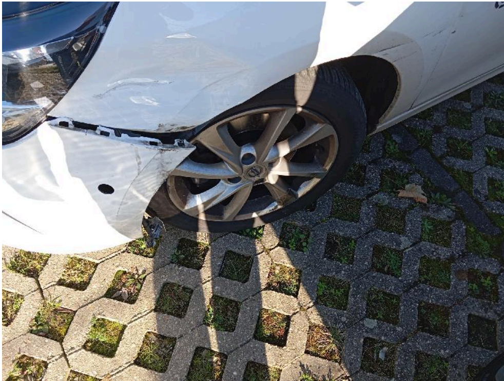
Bild: 11 Rad vorne links Fehlstellung
