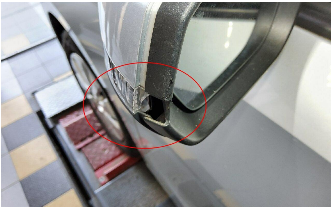
Bild 16 : Spiegelrahmen und Spiegelblinker gebrochen
