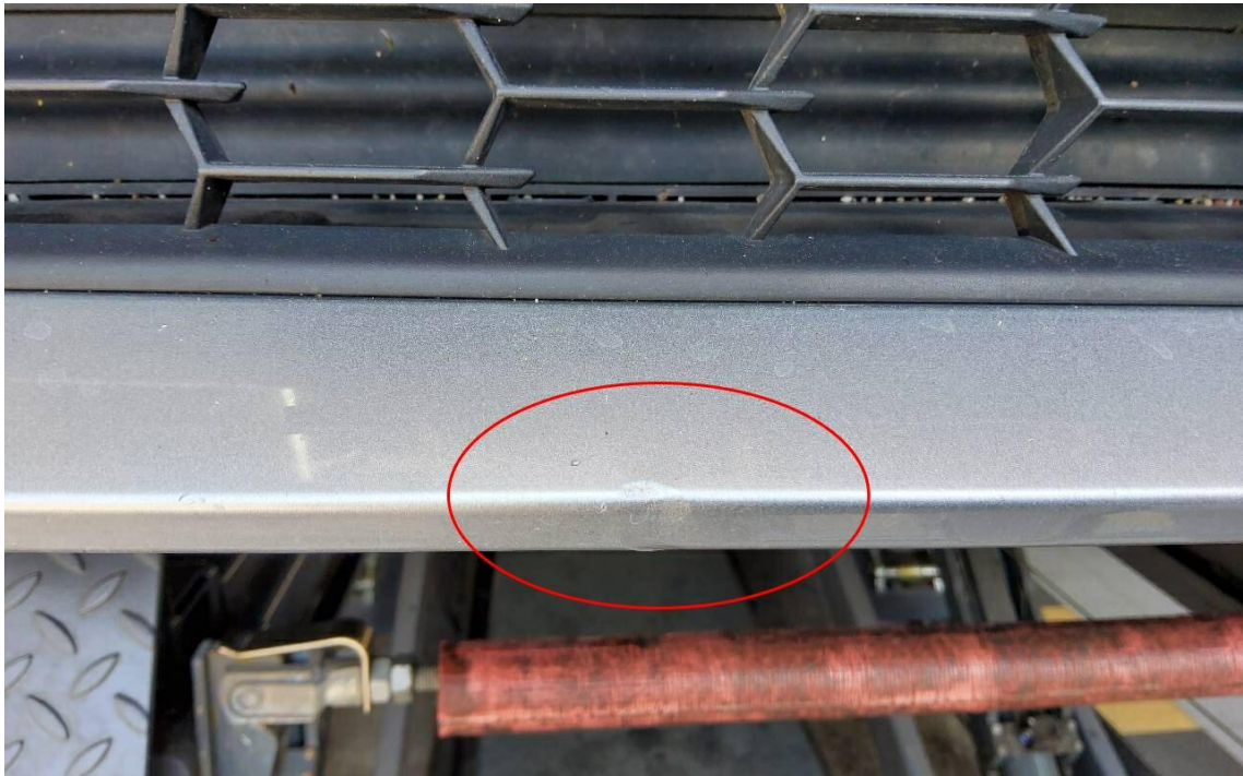
Bild 25 : Stoßfängerverkleidung vorne Lackbeschädigungen
