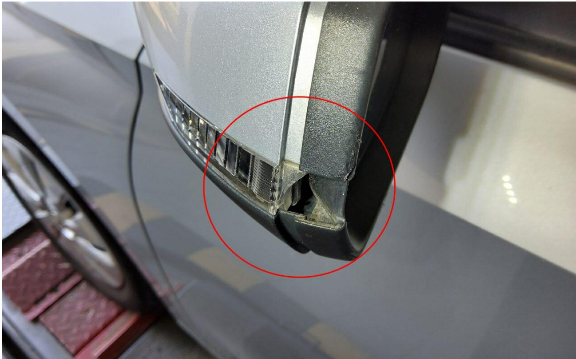
Bild 15 : Spiegelrahmen und Spiegelblinker gebrochen
