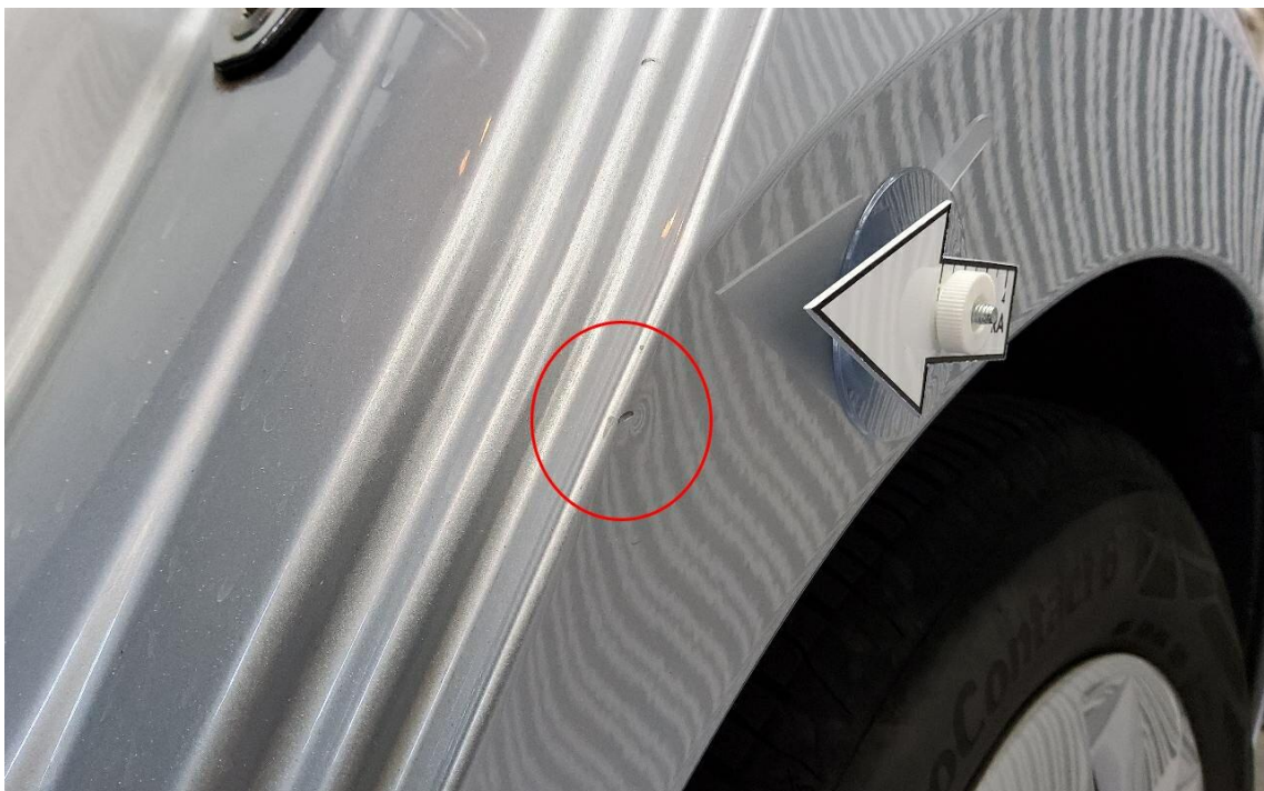
Bild 20 : Seitenwand hinten links Kratzer und Delle
