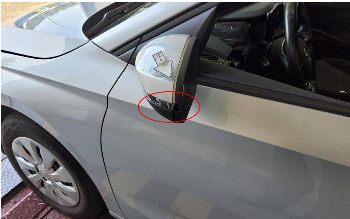
Bild 14 : Spiegelrahmen und Spiegelblinker gebrochen
