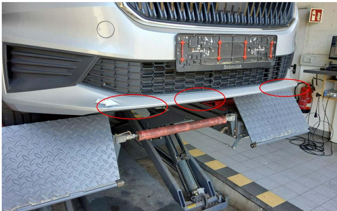
Bild 22 : Stoßfängerverkleidung vorne Lackbeschädigungen
