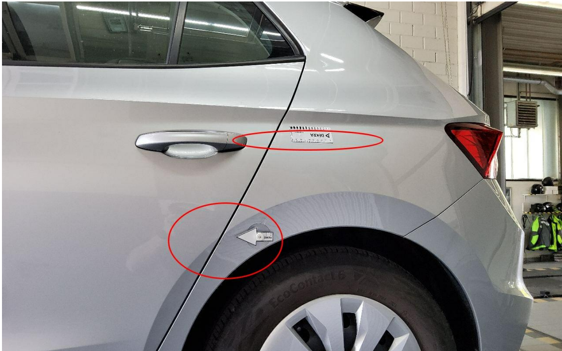
Bild 19 : Seitenwand hinten links Kratzer und Delle
