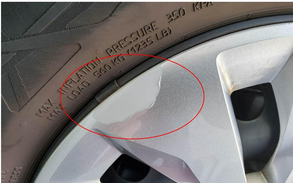
Bild 30 : Radzierblende vorne rechts Lackbeschädigungen
