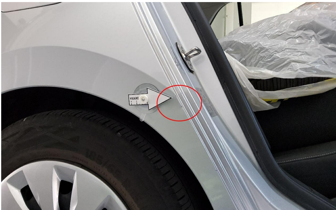
Bild 26 : Seitenwand hinten rechts Delle mit Lackbeschädigung
