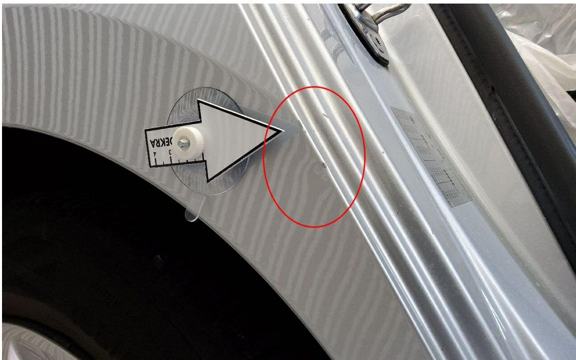
Bild 28 : Seitenwand hinten rechts Delle mit Lackbeschädigung
