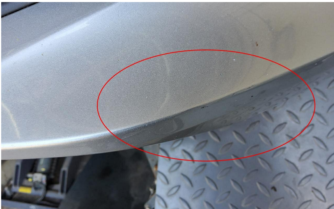
Bild 24 : Stoßfängerverkleidung vorne Lackbeschädigungen
