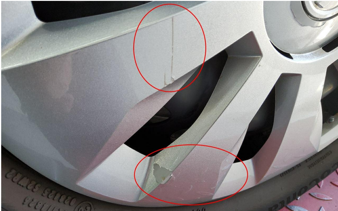
Bild 31 : Radzierblende vorne rechts Lackbeschädigungen
