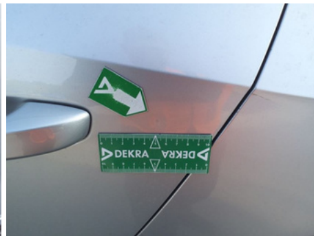
Porte / Arrière Gauche / Enfoncement
