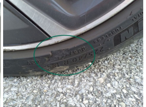
Pneu / Avant Gauche / Déchiré
