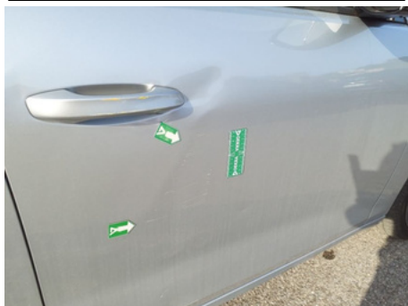
Porte / Avant Droit / Enfoncement
