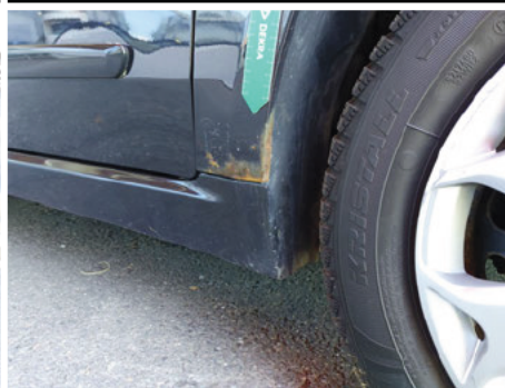
Kotflügel / Vorne Rechts / Rost
