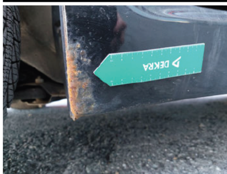
Schweller / Links / Rost
