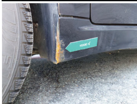
Schweller / Links / Rost
