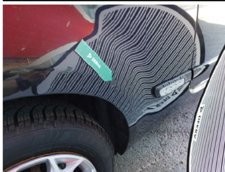
Kotflügel / Hinten Rechts / Delle
