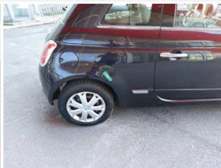
Kotflügel / Hinten Rechts / Delle
