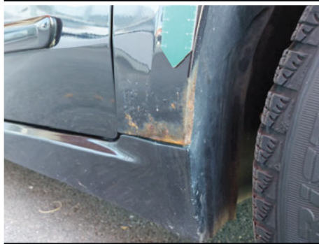
Kotflügel / Vorne Rechts / Rost
