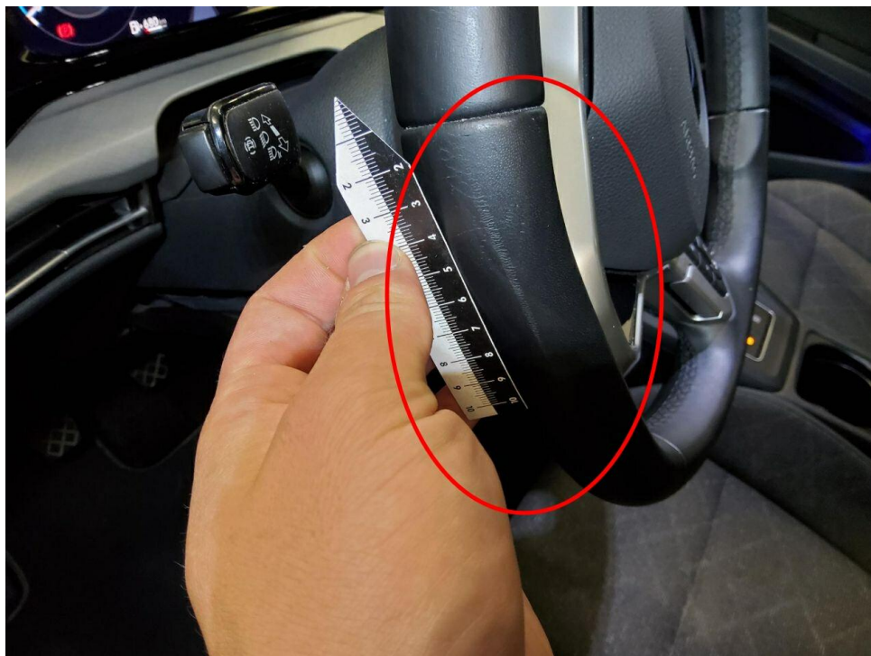
Bild 14 : Lenkrad, zerkratzt, smart repair
