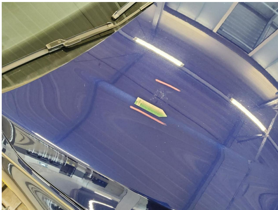
Bild 18 : Motorhaube Lackierung, Umweltschaden, lackieren mit Lackaufbau
