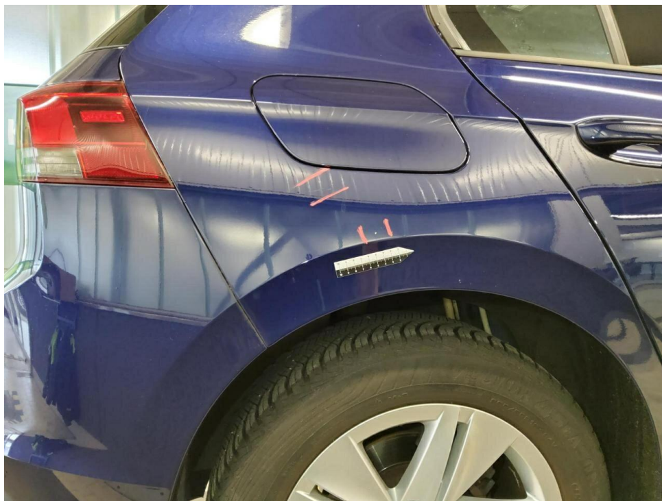
Bild 30 : Seitenteil hinten rechts Lackierung unterhalb, zerkratzt, lackieren mit Lackaufbau
