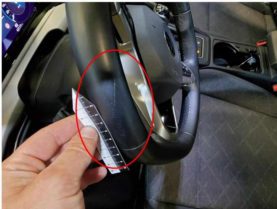
Bild 15 : Lenkrad, zerkratzt, smart repair
