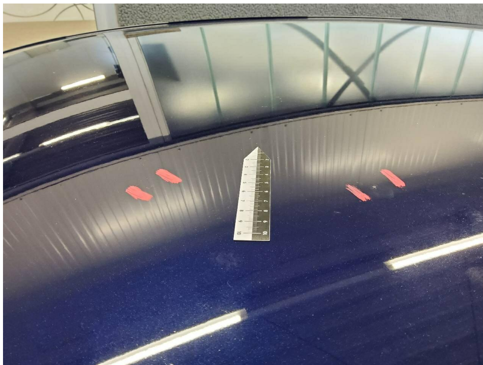
Bild 33 : Dach, Lackierung, Umweltschaden
